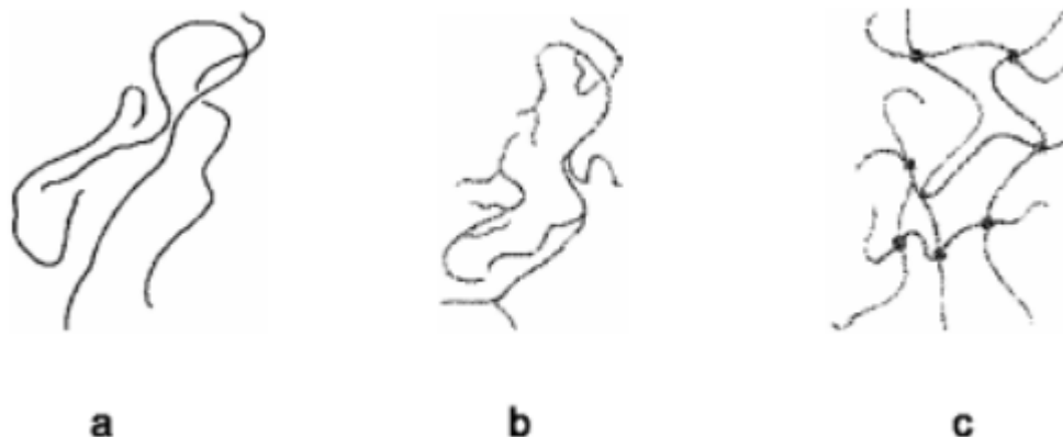
obr. 3.2: Tvary makromolekul a) lineární b) rozvětvené c) prostorově síťované [18]
