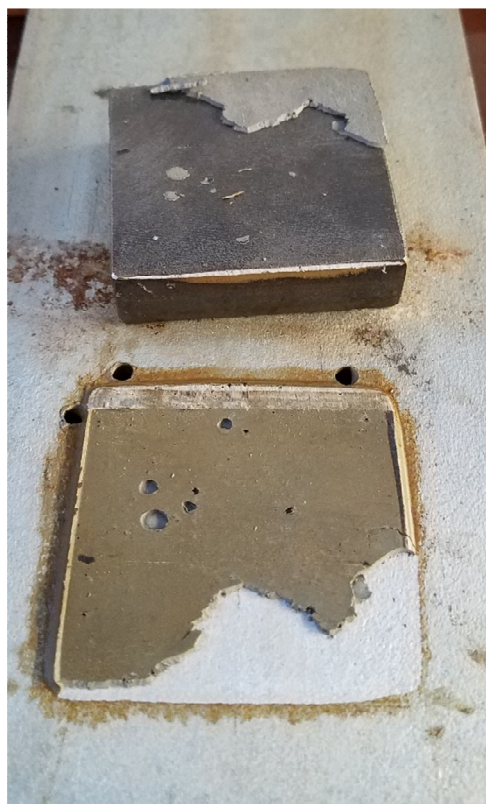
obr. 7.28: Adhezní porušení od obou substrátů (zinek / ocel) – vzorek č. 1 (vlevo) a vzorek č. 2 (vpravo) ze sady za teploty 230°C, viditelné bublinky ve vrstvě lepidla
