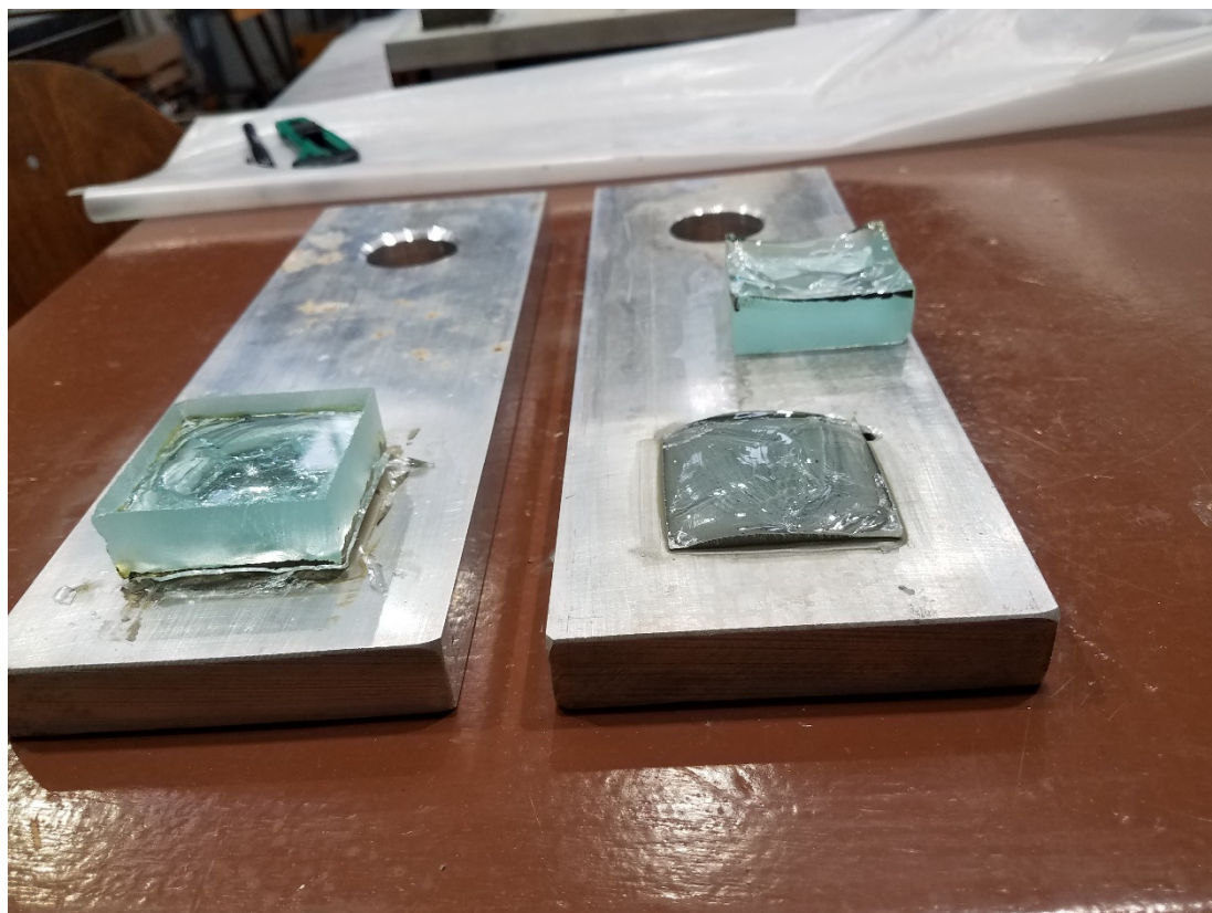
obr. 7.21: Porušení zkušebních vzorků se skleněným substrátem při vytvrzování, porušení je totožné pro vzorky ochlazované rychleji (vlevo) a pozvolna (vpravo)
