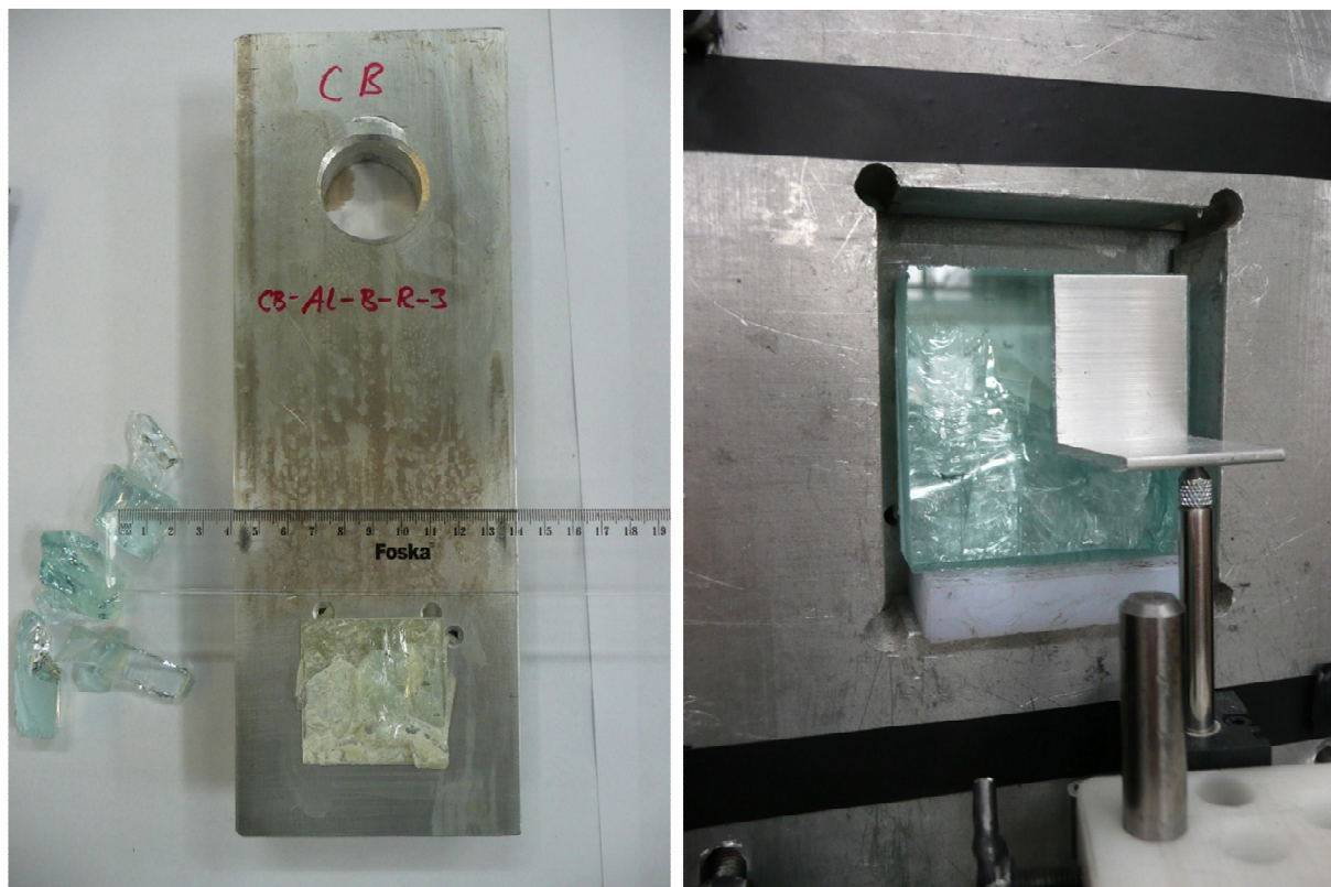
obr. 7.9: Porušení substrátu u vzorku č. 3 referenční sady sklo - hliník (vlevo) a u vzorku č. 1 (vpravo) – zde je vidět nalepený L úhelničiek s potenciometrem
