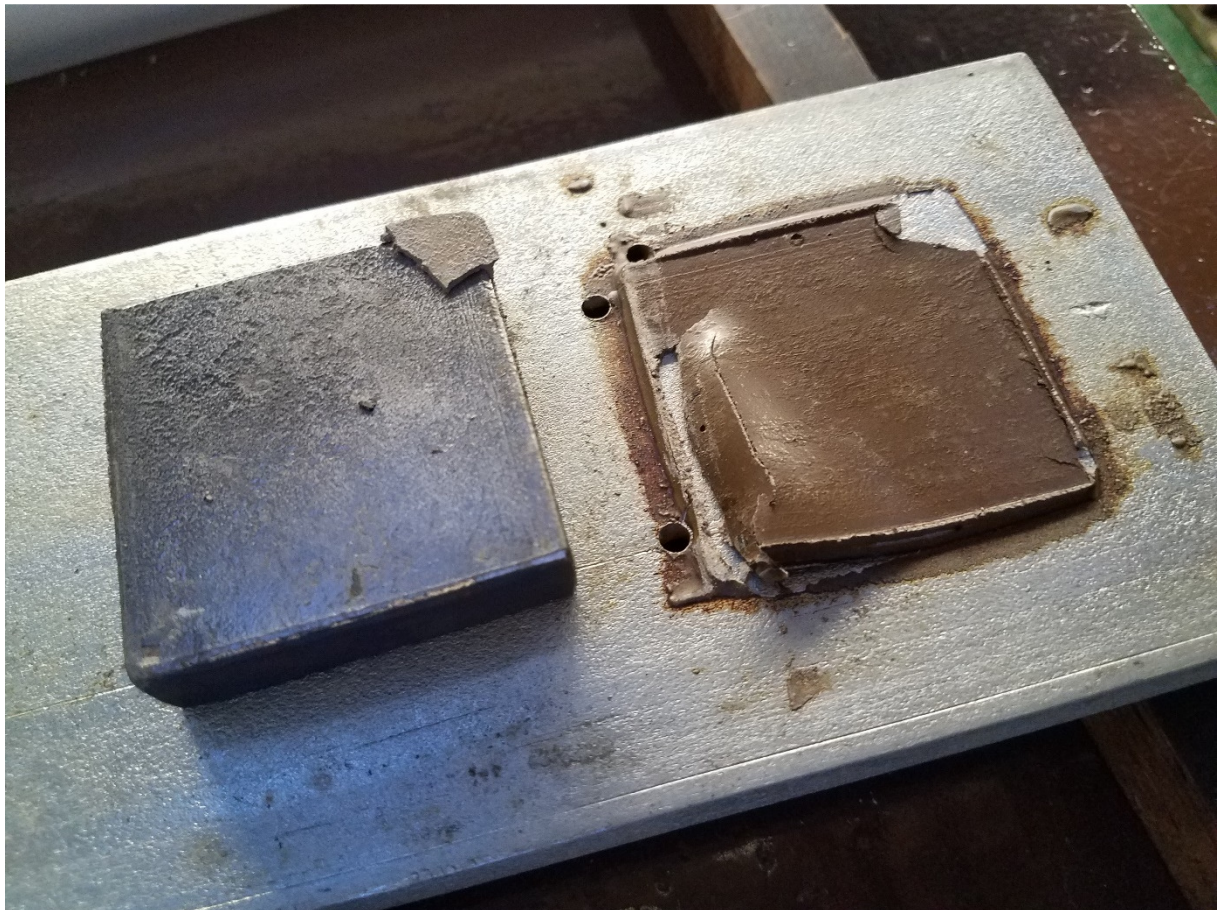
obr. 7.30: Adhezní porušení od ocelového povrchu – zadní část vzorku č. 4
