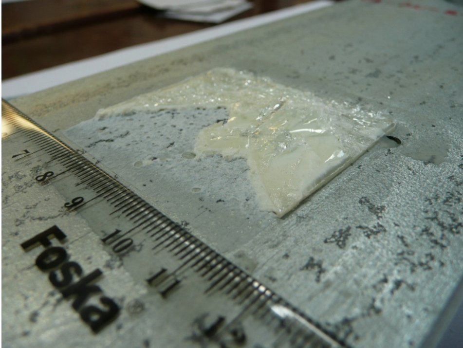
obr. 7.14: Viditelná plocha adhezního porušení od pozinkovaného povrchu a kohezní porušení na tenké hranici, kde se lepidlo přetrhlo – vzorek č. 3 z referenční sady sklo – ocel
