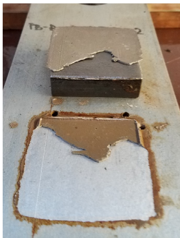
obr. 7.28: Adhezní porušení od obou substrátů (zinek / ocel) – vzorek č. 1 (vlevo) a vzorek č. 2 (vpravo) ze sady za teploty 230°C, viditelné bublinky ve vrstvě lepidla
