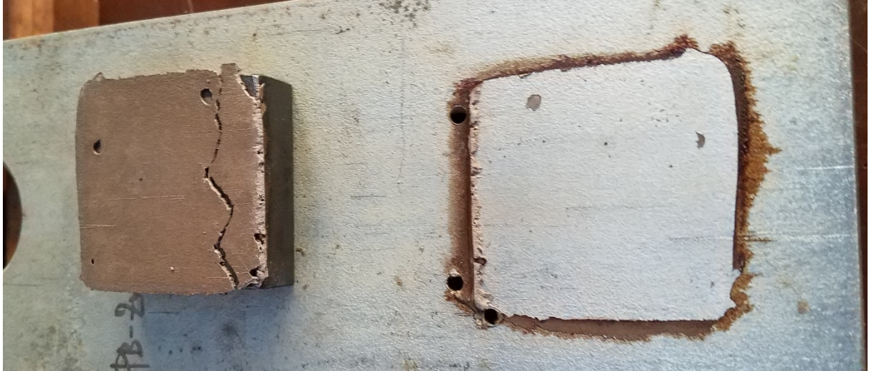
obr. 7.29: Adhezní porušení od zinkového povrchu – přední část vzorku č. 4
