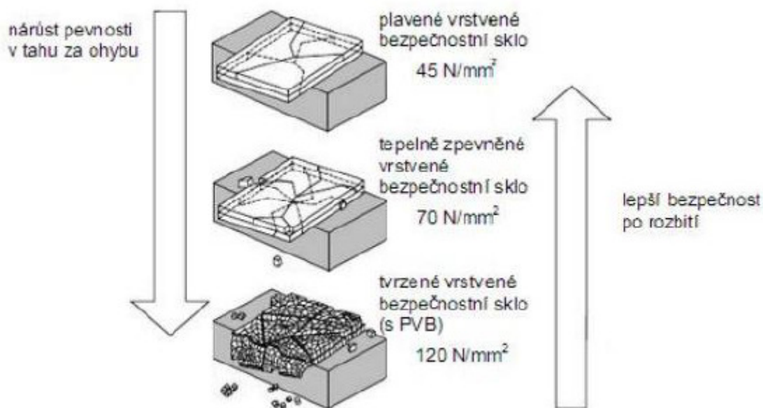
obr. 2.8: Rozdíl v porušení různých druhů vrstveného skla [6]
