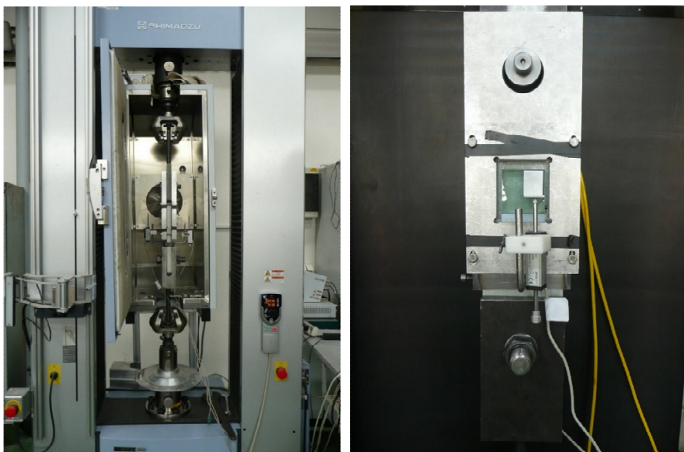
obr. 7.6: Zkušební sestava v peci (vlevo) a sestava referenční sady (vpravo)
