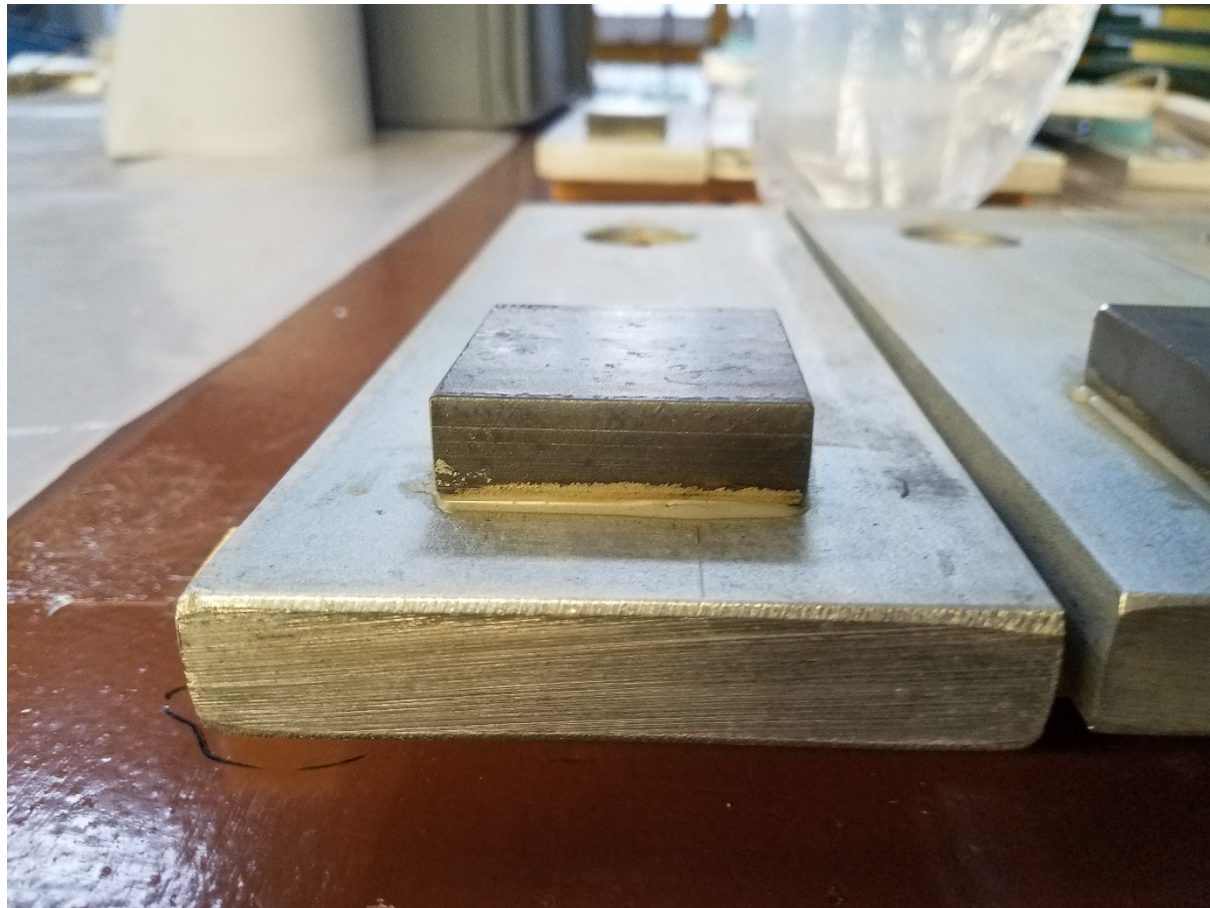
obr. 7.22: Náhradní řešení, nalepený vzorek s ocelovým středovým plechem a ocelovým bočním dílcem
