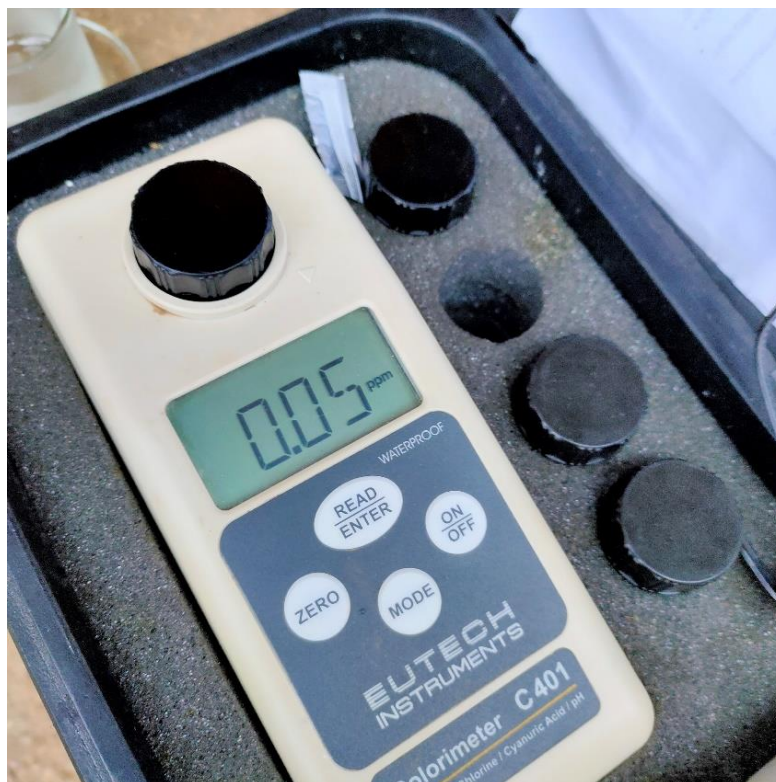
Obr. č. 50 Měření volného chloru ve vodovodní síti.
