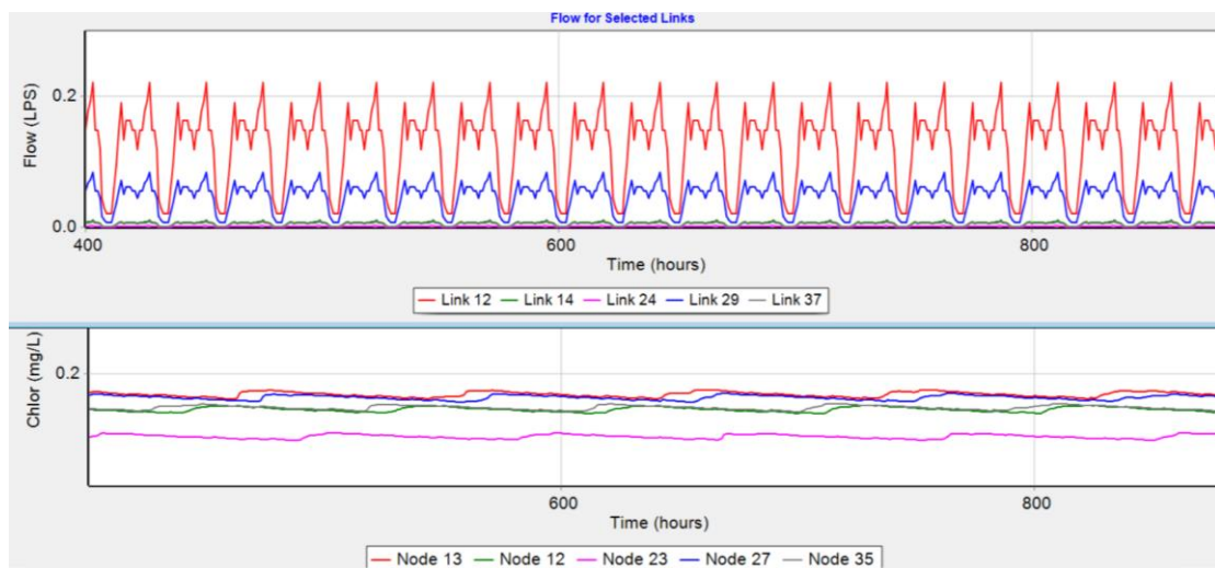
Obr. č. 55 Závislost koncentrace volného chloru na průtoku v obci Sněhov
