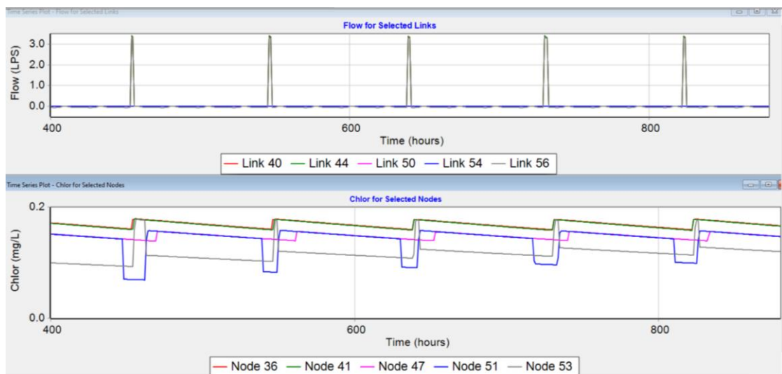
Obr. č. 53 Závislost koncentrace volného chloru na průtoku před VDJ Filka.
