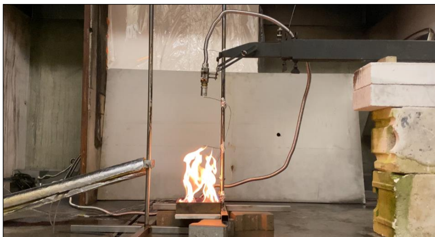
Obrázek 18: Fotografie z průběhu hašení etanolu s tryskou ve výši 75 cm nad hranou nádoby
