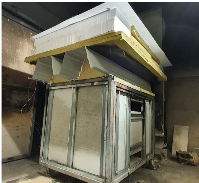
Obr. 51: Zkušební vzorek č. 2 na zkušebním zařízení, těsnění po obvodě z minerální izolace je vyplněno silikonovým tmelem
