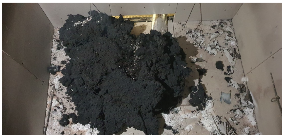
Obr. 74: pohled do zkušebního zařízení, černý materiál je napěněný grafit z intumescentního pásku manžety
