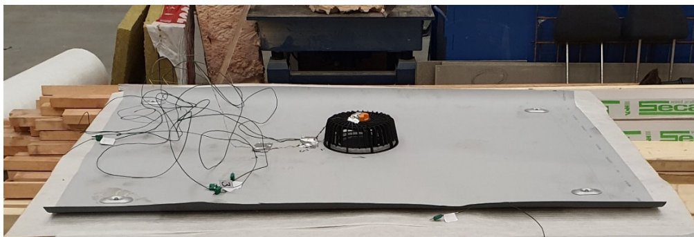
Obr. 63: zkušební vzorek č. 2, na levé straně si lze všimnout menšího zvlnění
