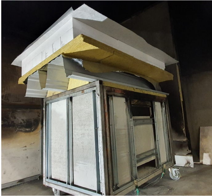
Obr. 50: zkušební vzorek č. 1 na zkušebním zařízení, v místě uložení je kolem obvodu provedeno těsnění pomocí minerální vlny
