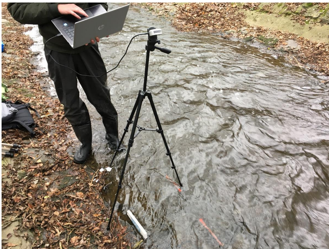
Obrázek 26 - Příprava na měření pomocí kamery LiDAR L515
