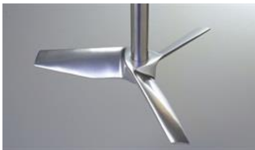
Obrázek 6 Axiální míchadlo A310/510 doporučeno pro míchání nízko viskózních médií.
