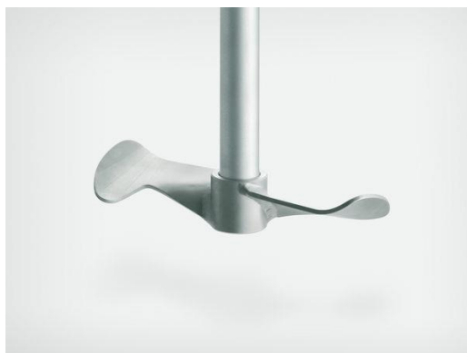
Obrázek 10 Míchadlo Isojet vhodné pro homogenizaci a suspendaci ve vysokých nádobách.
