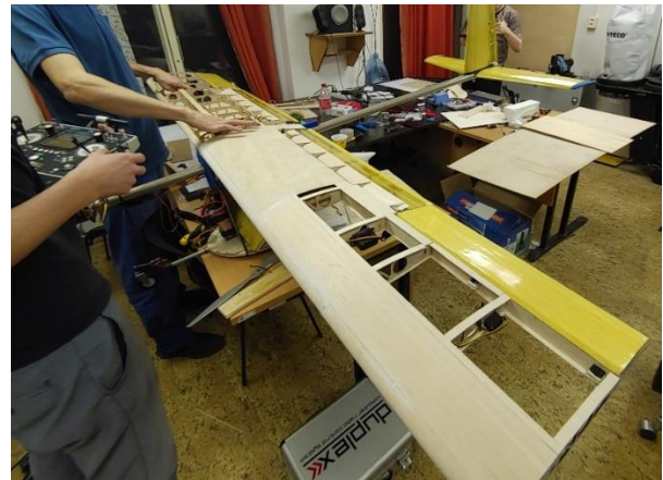
Obrázek 11-10: Kontrola funkčnosti ovládní křídélek a klapek
