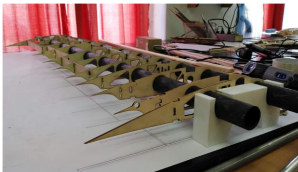
Obrázek 11-1: Ustavení žeber a stojin na trubkách
