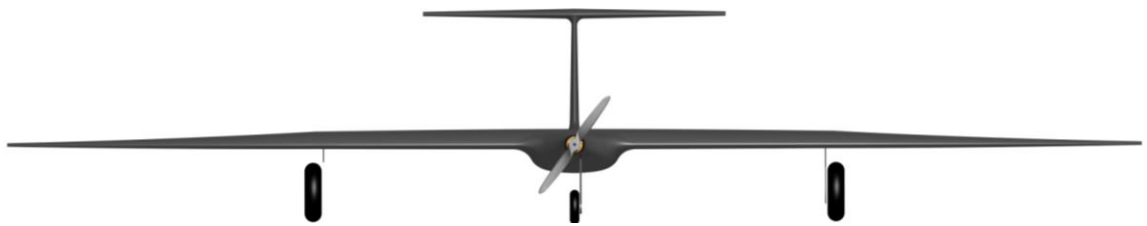
Obr. 85: Vzepětí koncových segmentů křídla 0°
