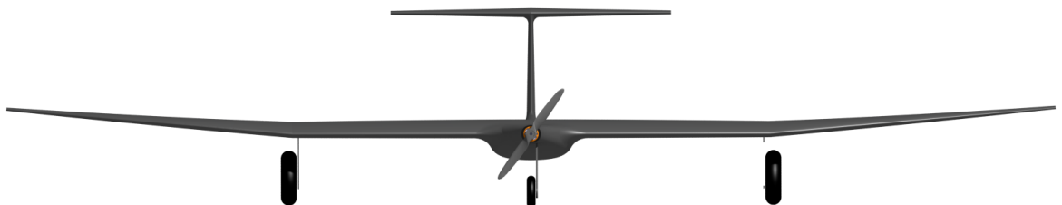
Obr. 86: Vzepětí koncových segmentů křídla 7°
