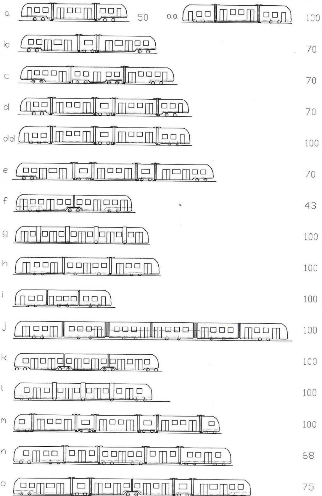
Obr. 3 - Koncepce vícečlánkových tramvají [1]
