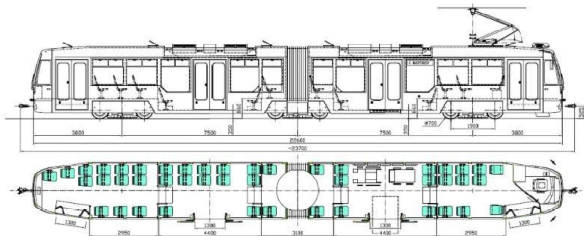
Obr. 6 - Schéma dvoučlánkové tramvajové jednotky se třemi otočnými podvozky [7]
