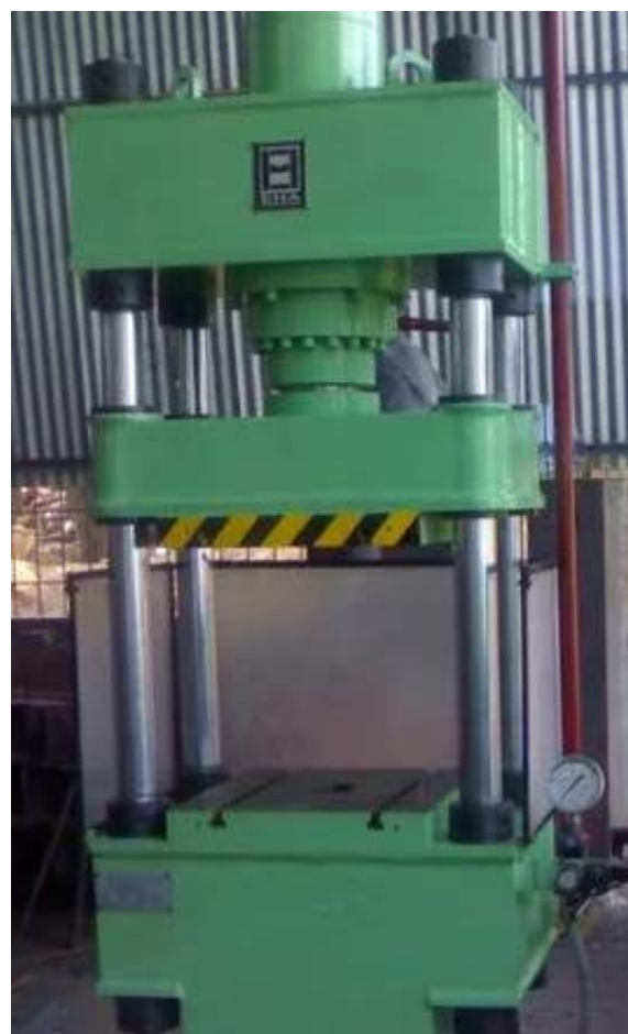
Obr. 9 – Kluzné sloupové vedení [5], čtyřsloupový lis [13]
