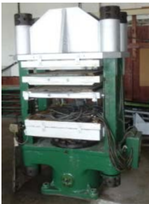
Obr. 20 – Hydraulický lis 288t – pohled před rekonstrukcí [23], schématické zobrazení
