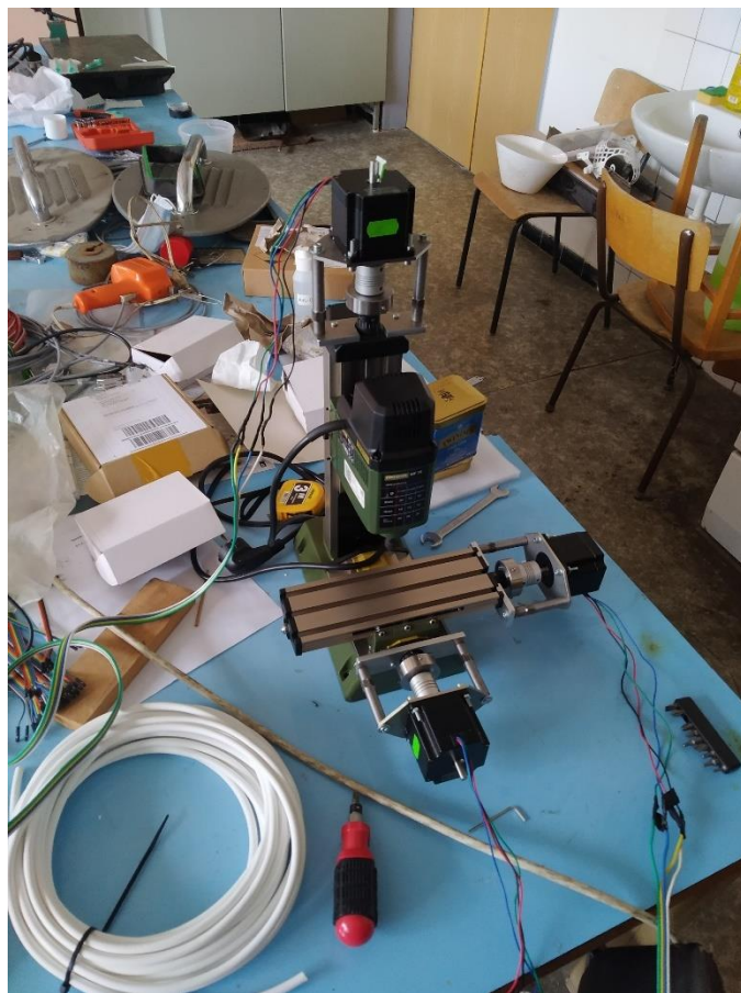
Obrázek 17 Frézka PROXXON MF70 po CNC úpravě
