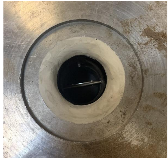
Obrázek 9 - Vstup do uklidňovací komory
