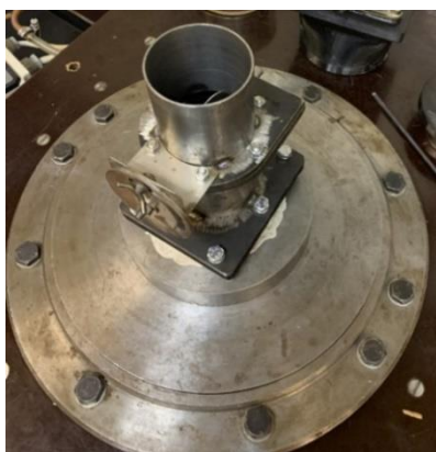
Obrázek 6 - Profukování sacího potrubí
