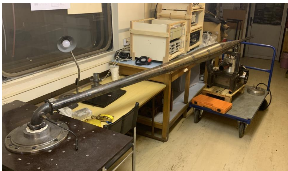
Obrázek 30 - Profukování výfuku v laboratoři na Julisce
