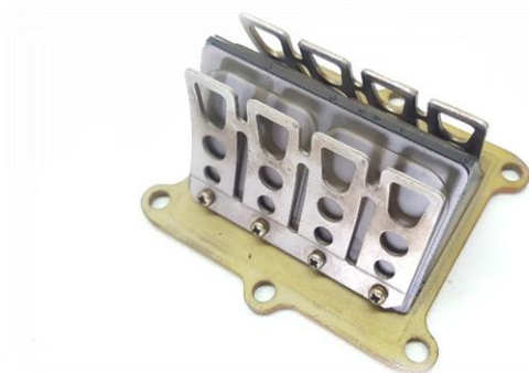
Obrázek 11 - Jazýčkový ventil Honda CR 500 [7]
