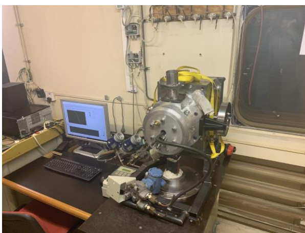
Obrázek 25 - Experimentální profukování celého motoru
