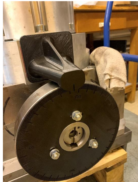
Obrázek 21 - Mechanismus pro určení polohy HÚ
