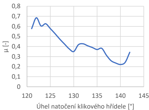
Graf 11 - Výsledný průběh \mu plnicích kanálů
