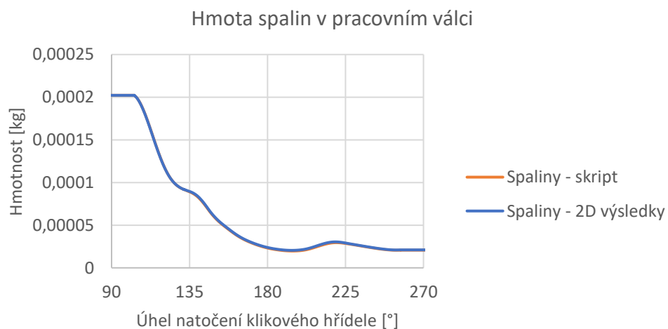
Graf 32 - Porovnání způsobů výpočtu hmoty spalin ve válci
