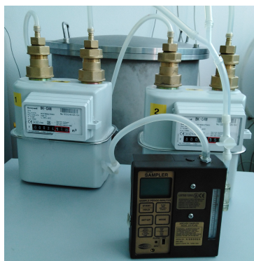
Obr. 8.4: Čerpadlo (v popředí) a dva průtokoměry (za čerpadlem).
