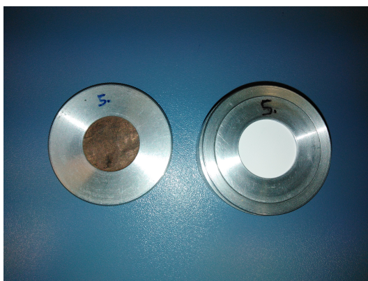
Obr. 5.1: Napravo je kovové pouzdro s filtrem MF Millipore [30] a nalevo mřížka, která se dá na pouzdro našroubovat. Plocha nepřekrytého filtru je rovna ploše nepřikryté mřížky.
