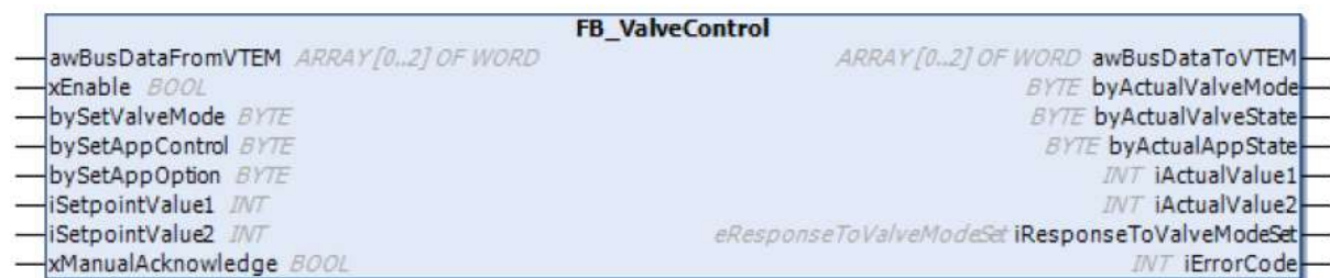
Obrázek 17 Funkční blok FB_ValveControl pro ovládání ventilu VEVN [27]
