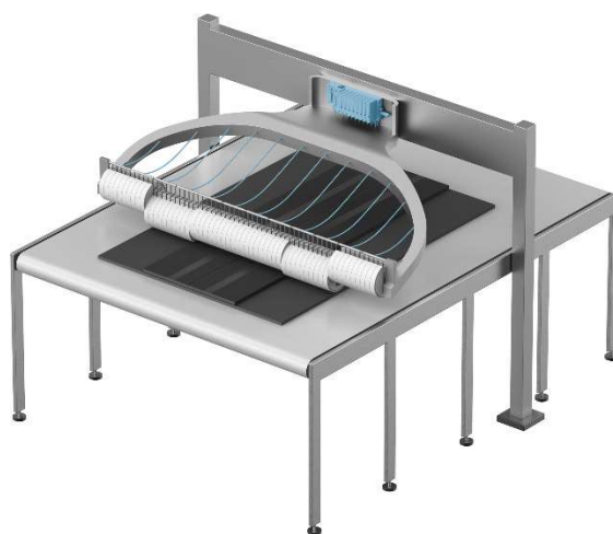
Obrázek 13 Vzorkovač gumy před výrobou pneumatik [26]
