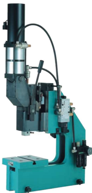
Obrázek 2 Pneumatický kolenopákový lis XL – NP [7]
