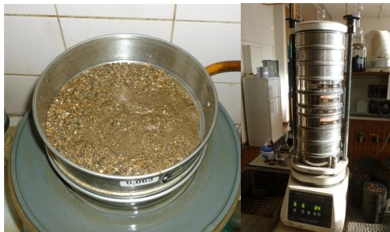
Obr. 83 Promývací a prosévací zařízení
