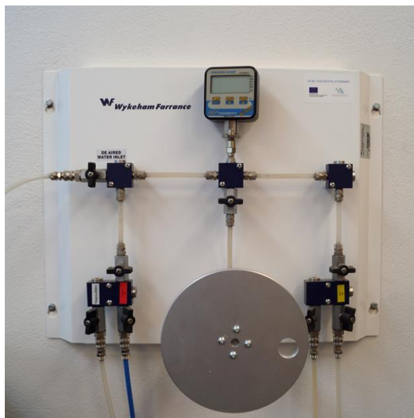
Obr. 40 Distribuční panel vody
