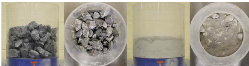
Obr. 61 Nový a degradovaný štěrk [23]
