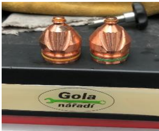
Obrázek 25-Na levé straně tryska pro metodu Contour cut a na pravé straně pro metodu Silent cut
