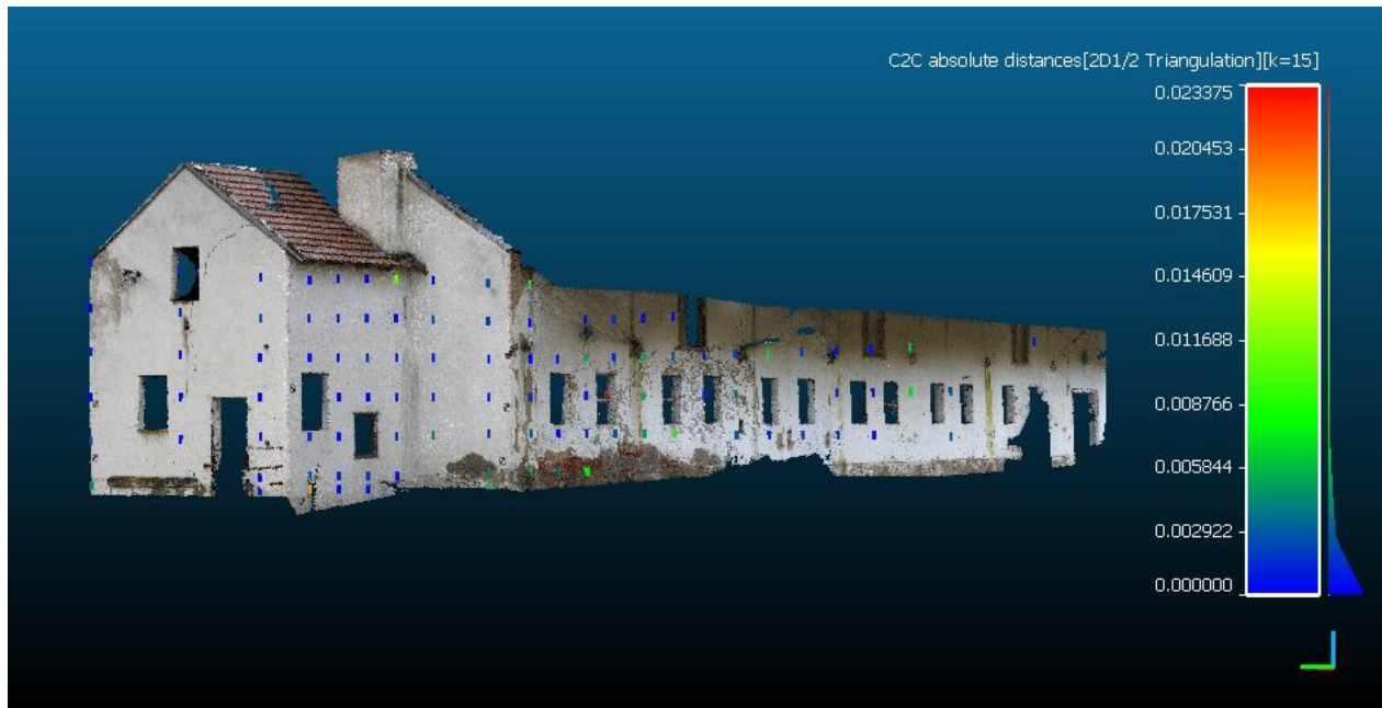
Obr. 8: Body skenování, které dopadly na fasádu objektu; většina vyobrazena modře, tedy s odchylkou menší než 3 mm.
