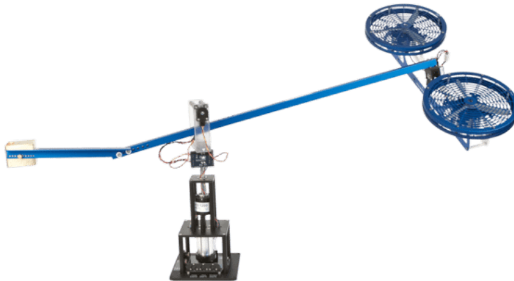
Obr. 3.1: Fotografie helikoptéry Quanser 3DOF. Převzato z [28]
