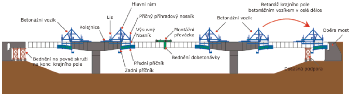
Obrázek 3 Schéma možnosti letmé betonáže vícepolové konstrukce [4]
