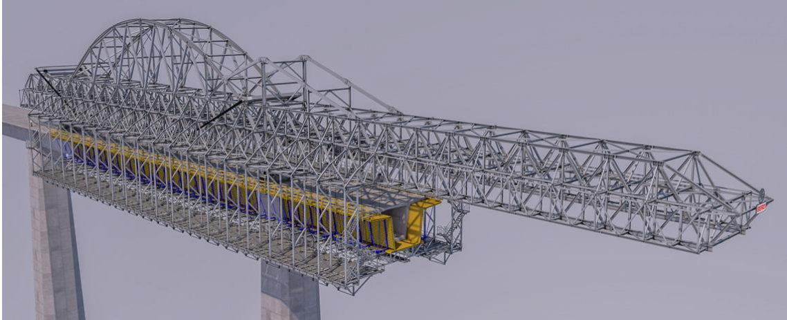
Obrázek 17 Vizualizace výsuvné skruže M1-90-S [16]
