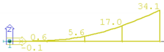
Obrázek 13 Průhyby při modelování betonáže do správné nivelety [10]
