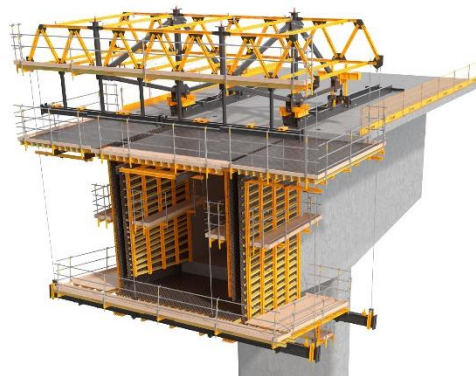
Obrázek 7 Vizualizace vozíku umístěného nad mostovkou - výrobce ULMA, prvkový systém MECCANO [5]
