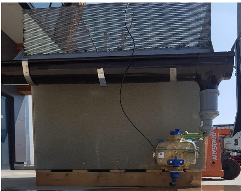
Obrázek 17: Detail sestavy pro sběr a měření odtoku z experimentální sestavy
