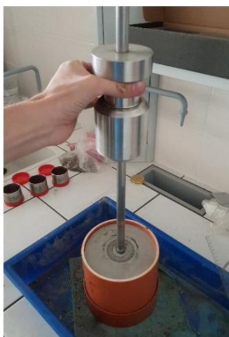
Obrázek 6: Perforované dno nádoby na měření MVK, zhutňování vzorku Proctorovým kladivem, měření výšky vzorku po zhutnění (zleva)
