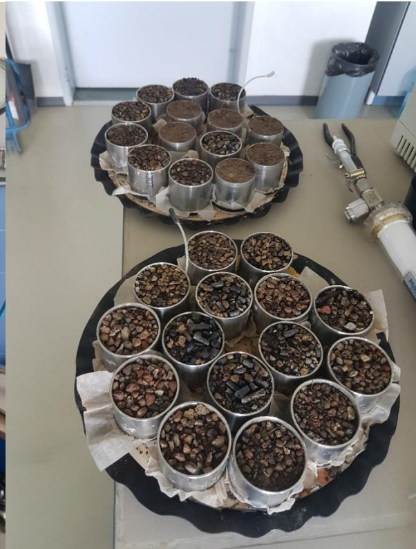
Obrázek 4: vzorky substrátů na keramické desce pro měření retenčních čar
