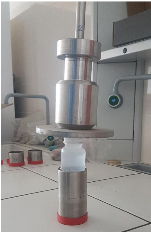
Obrázek 1: Sestava pro hutnění vzorku na měření retenční čáry
