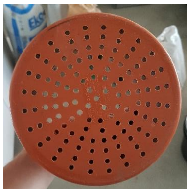
Obrázek 6: Perforované dno nádoby na měření MVK, zhutňování vzorku Proctorovým kladivem, měření výšky vzorku po zhutnění (zleva)
