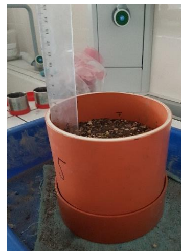
Obrázek 6: Perforované dno nádoby na měření MVK, zhutňování vzorku Proctorovým kladivem, měření výšky vzorku po zhutnění (zleva)
