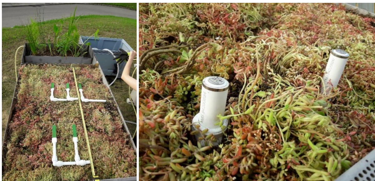
Obrázek 23: Poloha čidel a pohled na celá čidla před zapuštěním (vlevo), Poloha čidel po instalaci (vpravo)
