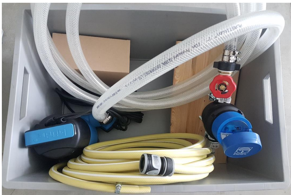
Obrázek 22: Předpřipravená aparatura pro čerpání předčištěné šedé vody do mokřadní části experimentální sestavy před instalací
