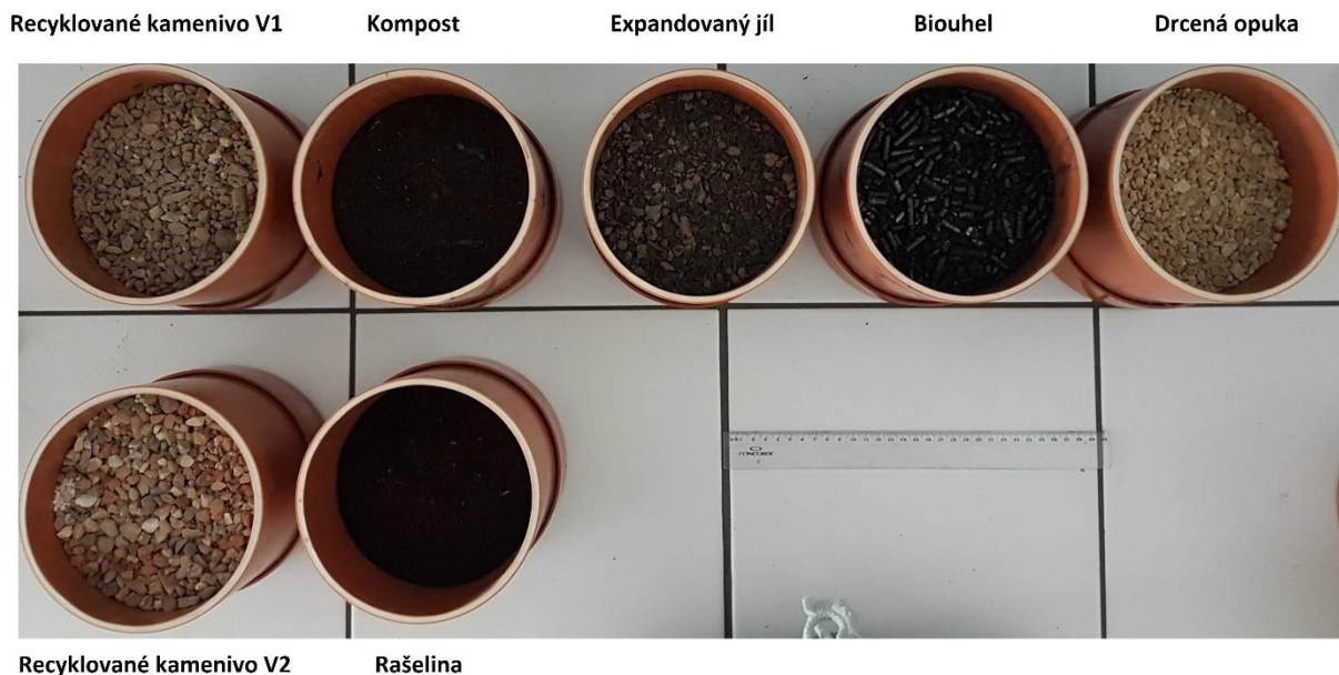
Obrázek 5: Vzorky materiálů použitých pro přípravu substrátů po zhutnění za účelem měření objemové hmotnosti
