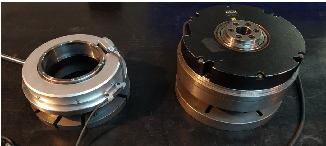
Obrázek 62: Optimalizovaná měřicí hlava (vlevo), hlava před úpravou (vpravo)
