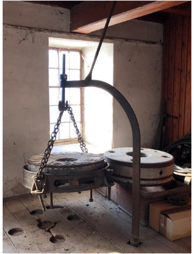
šrotovník kamenné mlecí složení 2np
