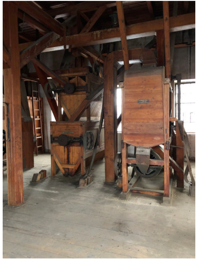
v levo - hranolový vysévač v pravo - aspirátor, triér 5np
