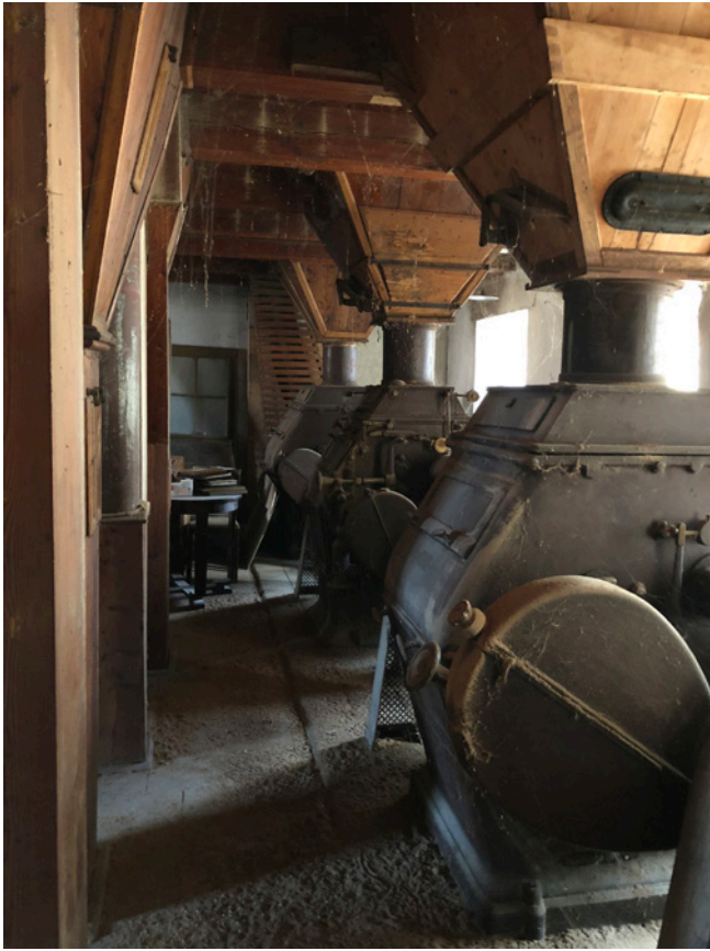
soustava válcových stolic 2np
