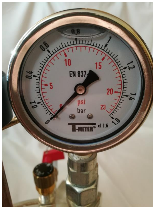
Obrázek 22: Manometr s rozsahem do 23 psi
