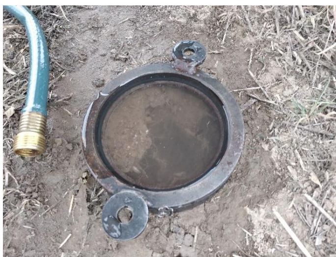
Obrázek 9: Základový prstenec Mini-JET zařízení, které bylo použito pro měření
