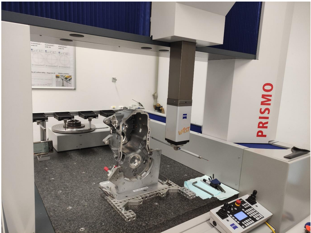
Obrázek 43 – Měření na CMM Carl Zeiss Prismo se skenovacím systémem Vast Gold
