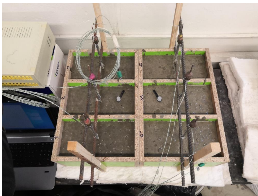
obr. 35 - Tělesa po betonáži
