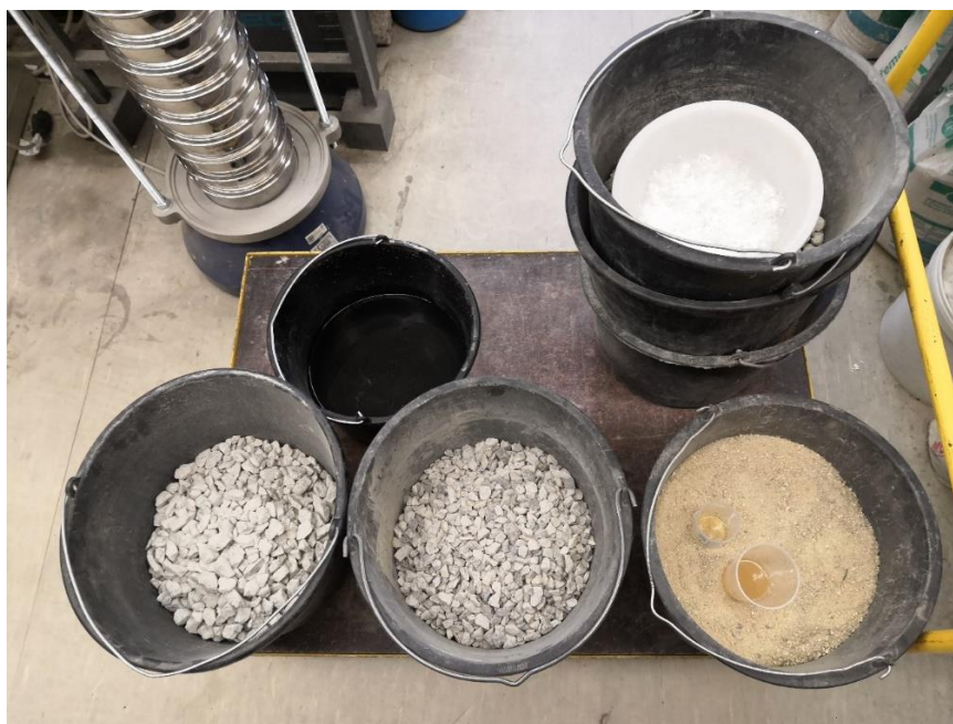
obr. 28 - Jednotlivé složky betonové směsi
