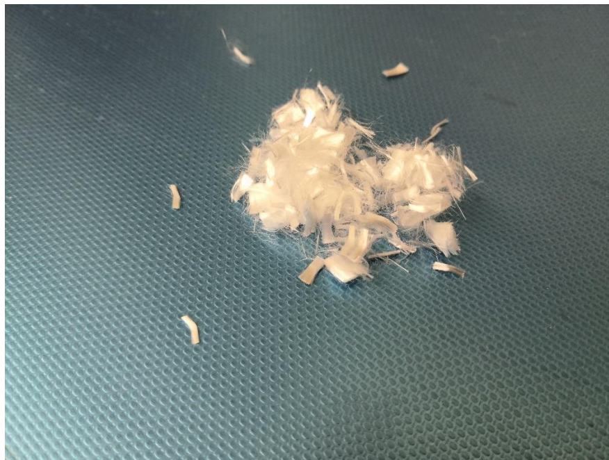
obr. 29 - Polypropylenová vlákna délky 6 mm obsažené v jednom typu betonových vzorků
