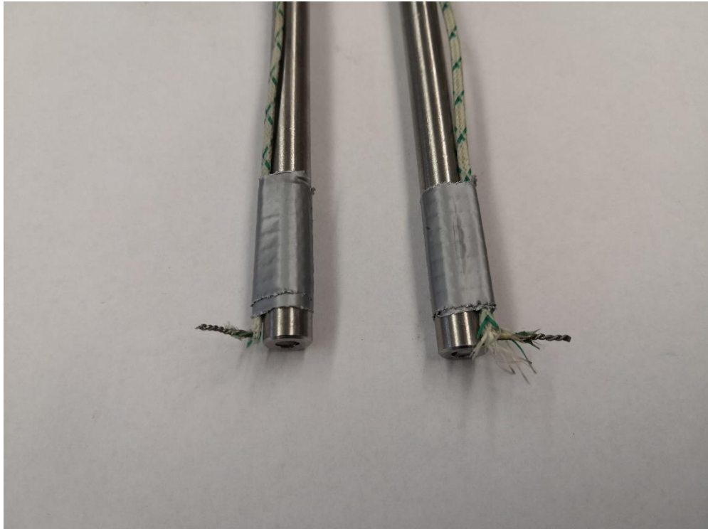
obr. 12 - Termočlánek upevněn na konci trubičky pro měření pórového tlaku
