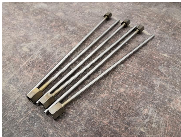
obr. 17 - Korozivzdorná trubička s navařeným zvnitřním závitem.
