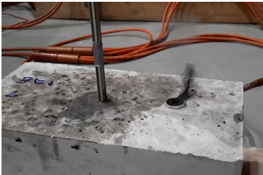
obr. 45 - Obrázek zachycující explozivní vystřelení gumového víčka Hygropinového pouzdra
