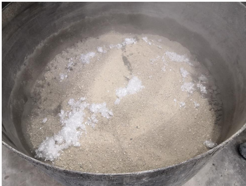
obr. 34 - Přidání polypropylenových vláken do suché směsi betonu před jejím zamíchání
