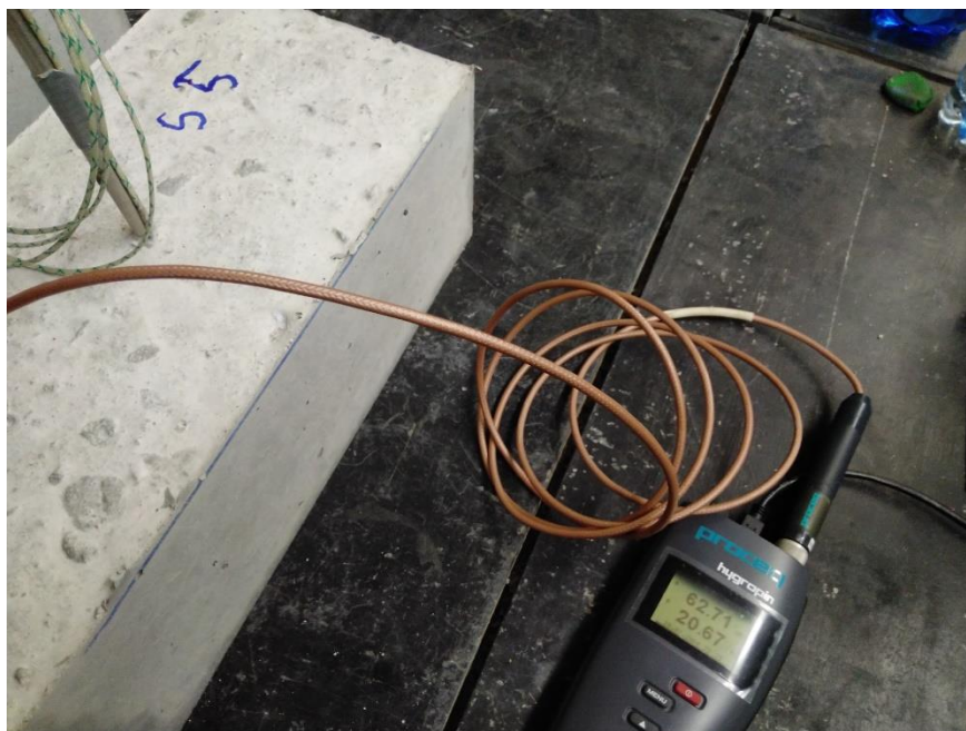
obr. 38 - Měření vlhkosti ve vzorku s PP vlákny
