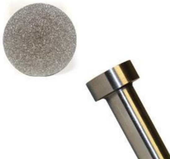
obr. 4 - Korozivzdorná trubička s navařeným kalíškem a slinutý porézni kov [15]
