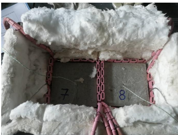
Obr. 61: Uložení betonových vzorků č. 7, 8, 9 při zatěžování vysokými teplotami
