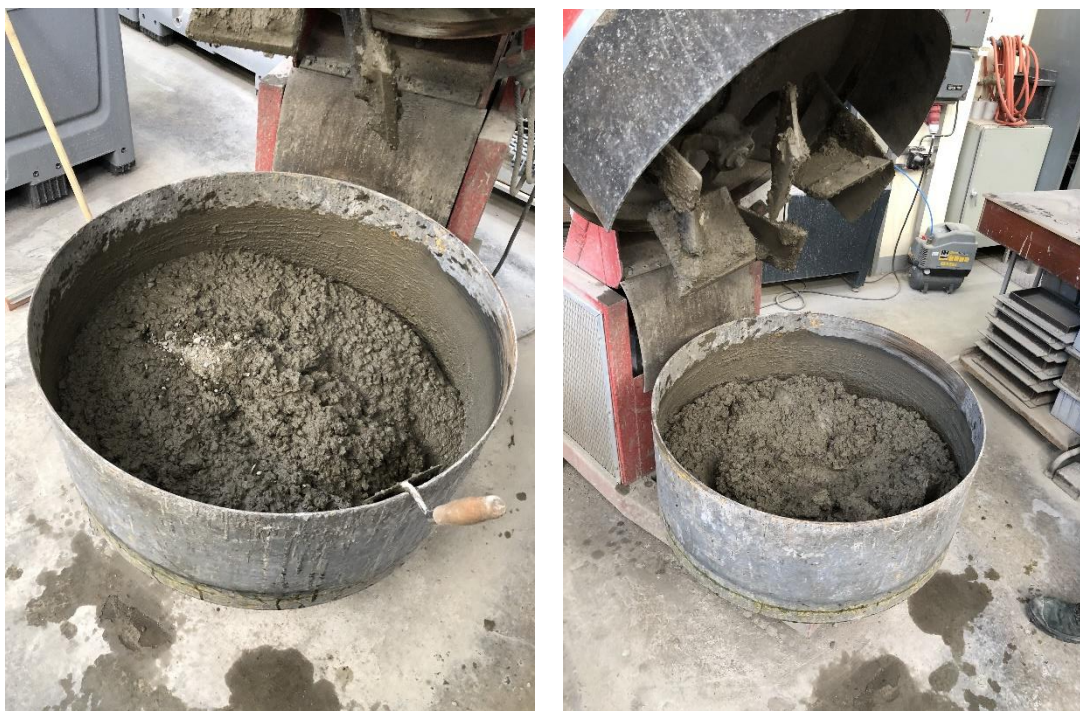
Obr. 42: Příprava betonové směsi v laboratorní míchačce
