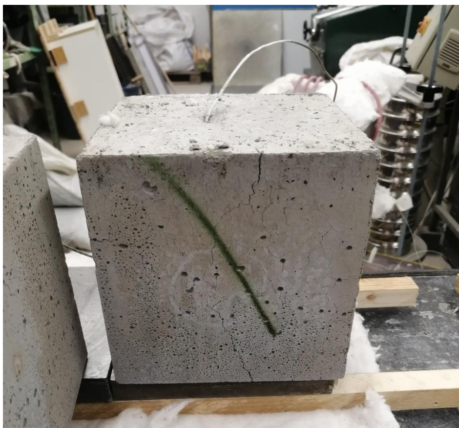
Obr. 66: Betonové těleso č. 7 – detail poškození vysokými teplotami
