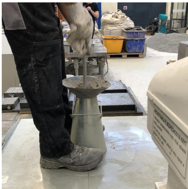
Obr. 43: Zkouška sednutí kužele
