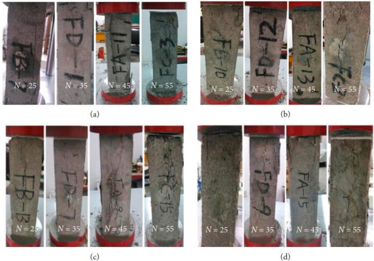
Obr. 28: Porušení betonových vzorků po různých zmrazovacích a rozmrazovacích cyklech a různých teplotách chlazených stříkající vodou: a) 20°C, b) 300°C, c) 400°C, d) 500°C. Převzato z [24]
