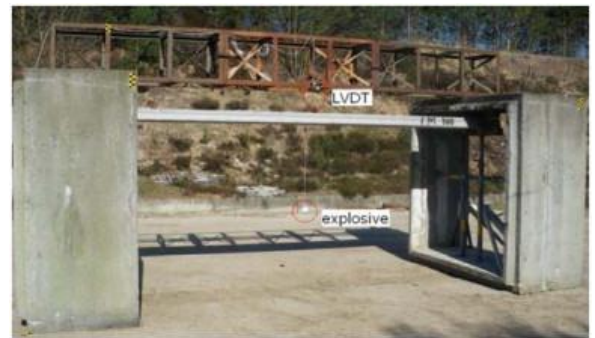
Obr. 13: (A) Nastavení během požárního zatížení; (B) Umístění výbušniny. Převzato z [18] [19]
