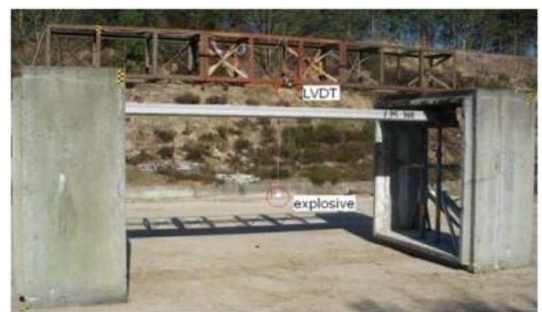
Obr. 11: (A) Nastavení během požárního zatížení; (B) Umístění výbušniny. Převzato z [18]
