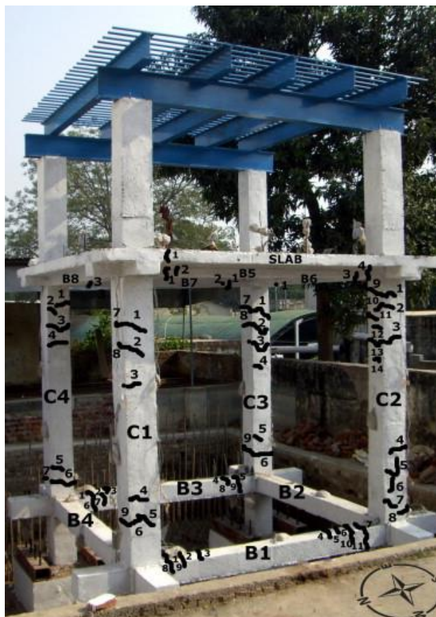
Obr. 19: Schéma trhlin způsobených seismickým zatížením. Převzato z [22]
