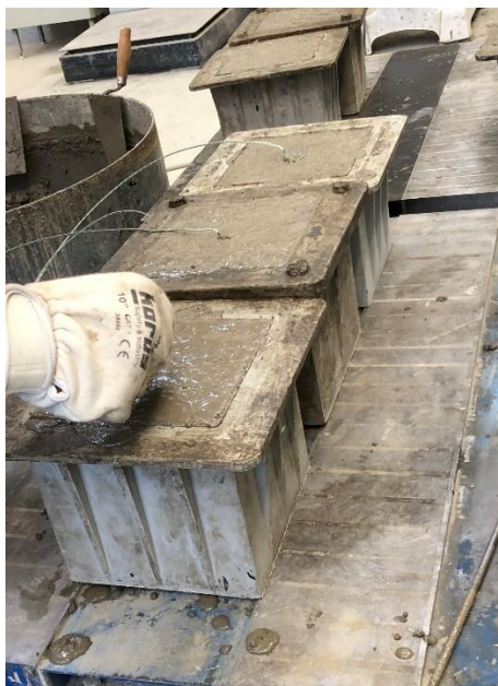
Obr. 63: Aplikace termočlánek při betonáži zkušebních těles
