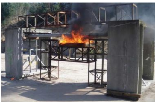
Obr. 11: (A) Nastavení během požárního zatížení; (B) Umístění výbušniny. Převzato z [18]
