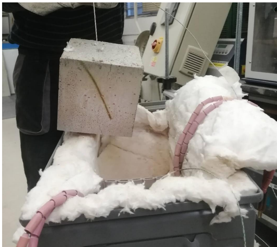
Obr. 65: Betonové těleso č. 7 – vyjmutí po zatížení vysokými teplotami
