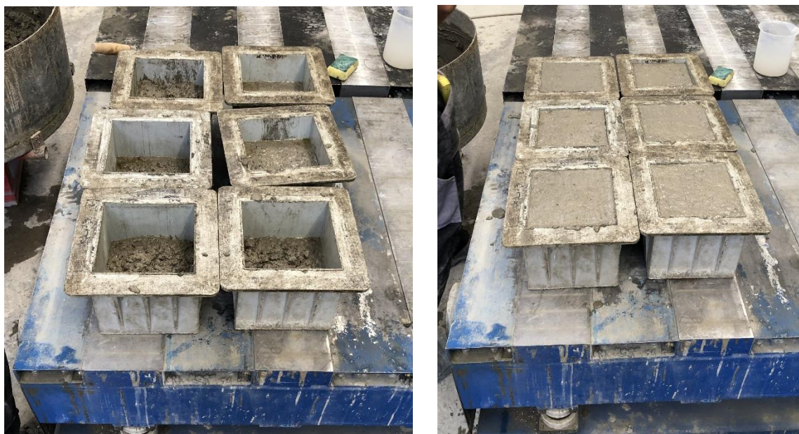
Obr. 45: Plnění forem a následné zhutnění zkušebních těles.
