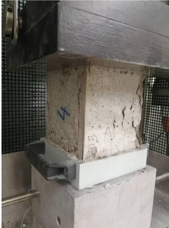
Obr. 58: Ukázka zkoušky pevnosti betonu v tlaku u vzorku č. 4
