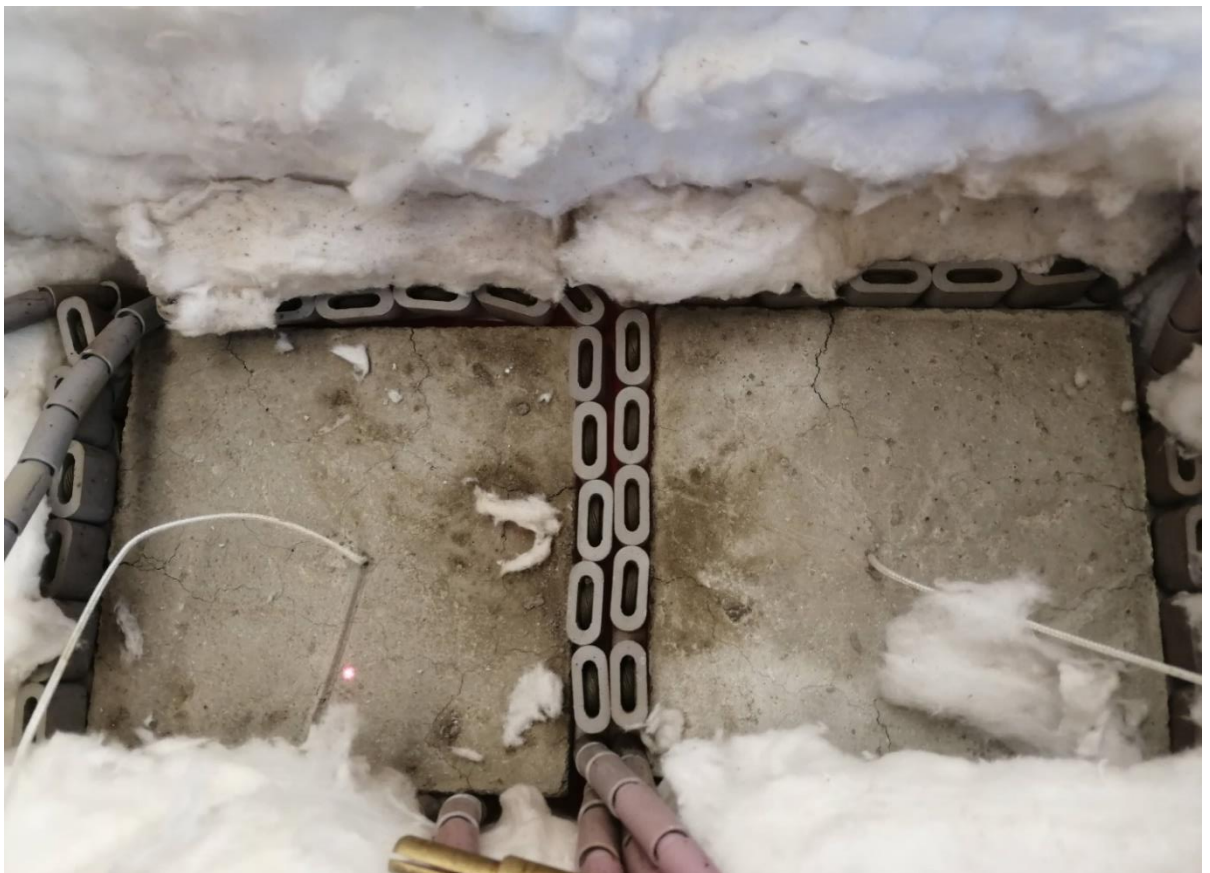
Obr. 64: Betonová tělesa č. 7 a 8 po zatížení vysokými teplotami
