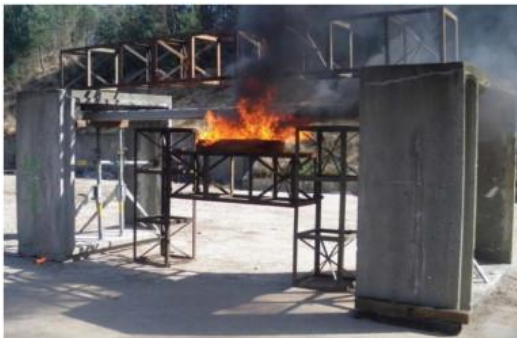
Obr. 13: (A) Nastavení během požárního zatížení; (B) Umístění výbušniny. Převzato z [18] [19]
