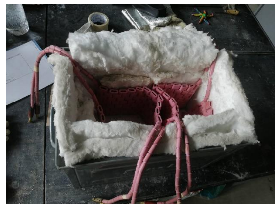
Obr. 61: Uložení betonových vzorků č. 7, 8, 9 při zatěžování vysokými teplotami
