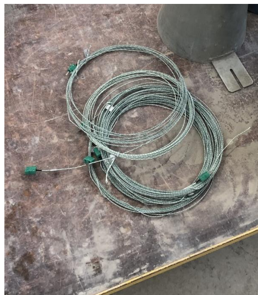
Obr. 63: Aplikace termočlánek při betonáži zkušebních těles
