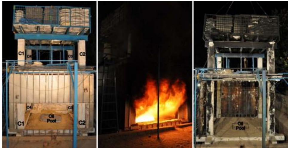
Obr. 20: a) zatížení simulovaným zemětřesením, b) požární zkouška, c) zkouška zbytkové tuhosti rámu. Převzato z [22]
