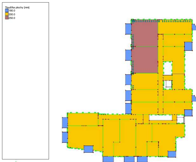
obr.34. 2D model stropní desky NP - tloušťky desek
