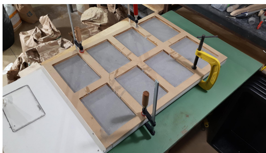
Obrázek 5.4: Vybetonované destičky v bednění
