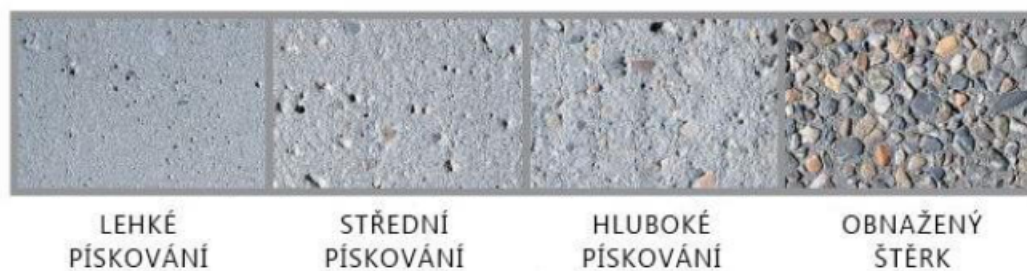
Obrázek 3.1: Možnosti pískování betonu [13]
