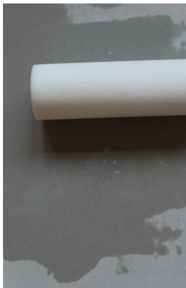
Obrázek 5.13: Aplikace 1. vrstvy sealeru na povrch D3 - ruční broušení a leptání kyselinou
