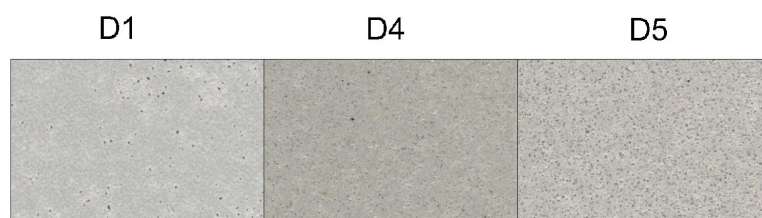
Obrázek 6.13: Porovnání struktury povrchu destiček D1 - bez povrchové úpravy, D4 - s ručním broušením, leptáním a sealerem a D5 - zbroušení diamantem
