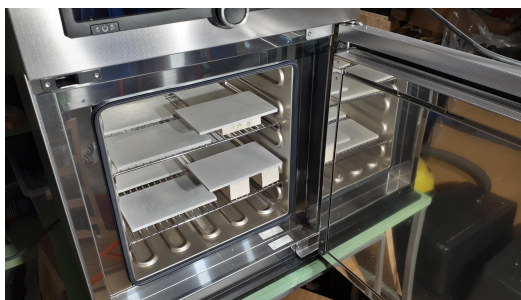
Obrázek 5.5: Betonové destičky ve vysoušecí komoře
