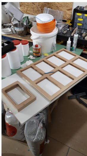
Obrázek 5.3: Zhotovené bednění pro výrobu destiček
