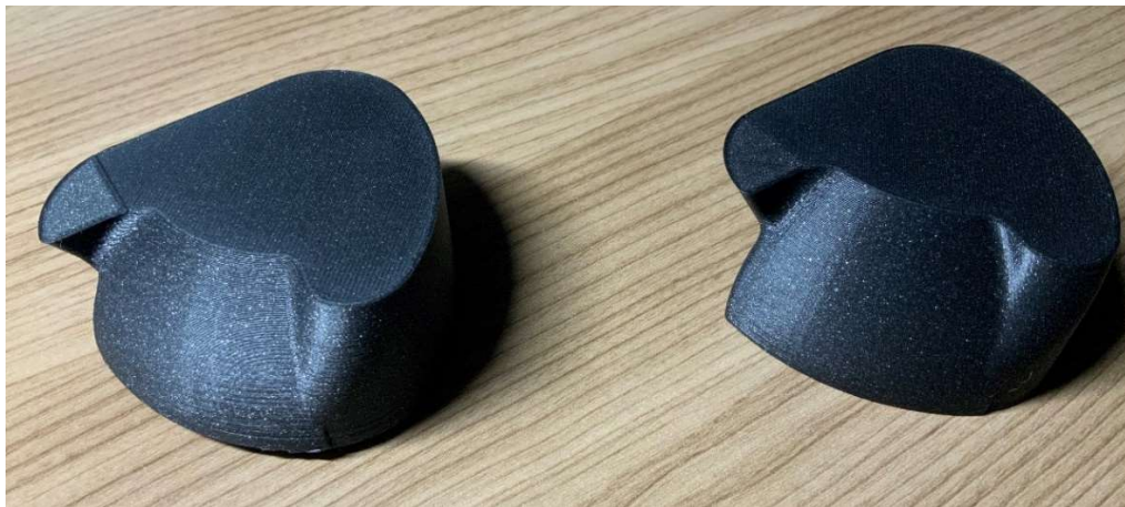
Obrázek 28 Výtisky před (vlevo) a po instalaci (vpravo) čipu TL Smootheru (kulová plocha)
