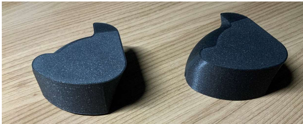
Obrázek 29 Výtisky před (vlevo) a po instalaci (vpravo) čipu TL Smootheru (oblá stěna)
