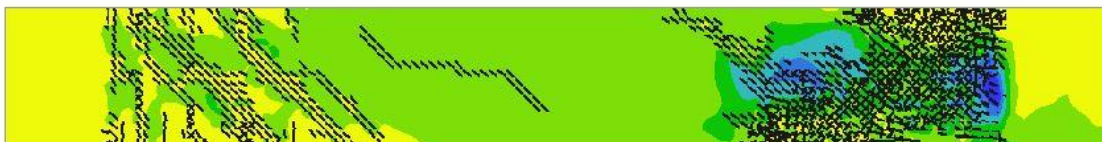
obr./50/ Způsob porušení prvku R6-15 (boční pohled)
