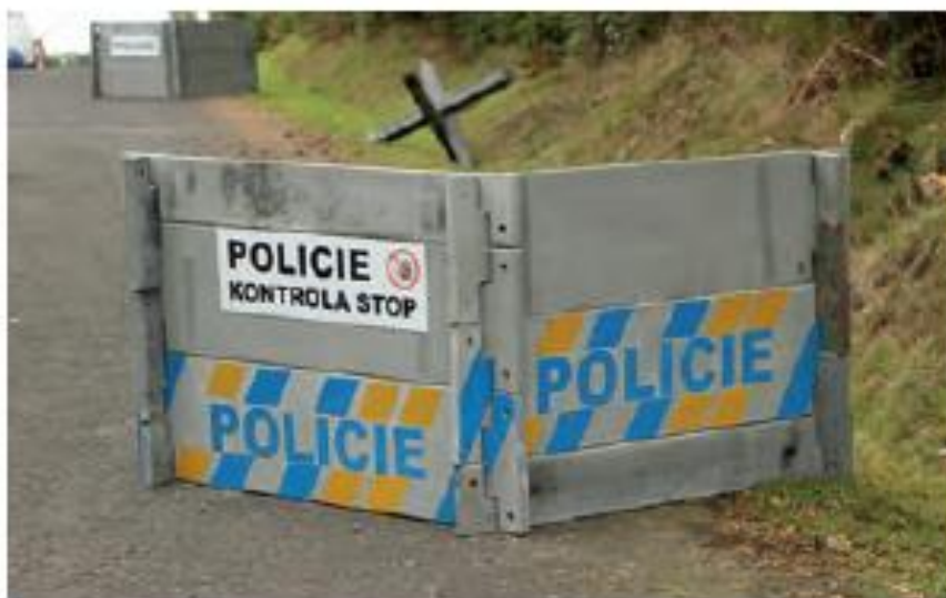
Obr. 17 Mobilní ochranná bariéra vyvinutá na Fsv ČVUT, zdroj: [33]
