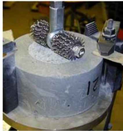
Obr. 18 Zkouška odolnosti proti obrusu, dle ASTM C944-99, [9]
