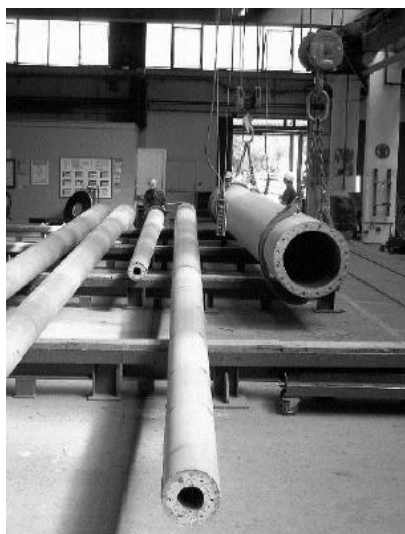
Obr. 47 Telekomunikační stožár vyrobený z UHPC výšky 22 m, zdroj: [40]
