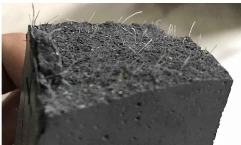
Obr. 5 Polymerová vlákna (PVA) po zkoušce pevnosti v tahu za ohybu, zdroj: [51]
