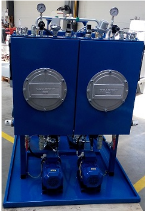
Obrázek 19 Mazací agregát (Zdroj: archiv Charvát Hykom s.r.o.)
