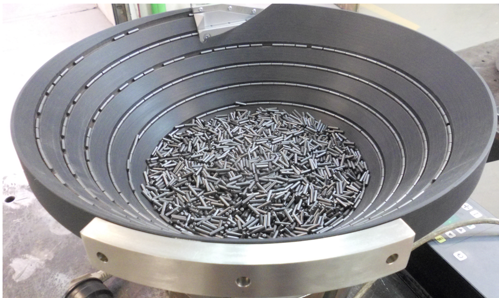
Obrázek 3.1: Kruhový zásobník podávající rovnoměrné válečky.
