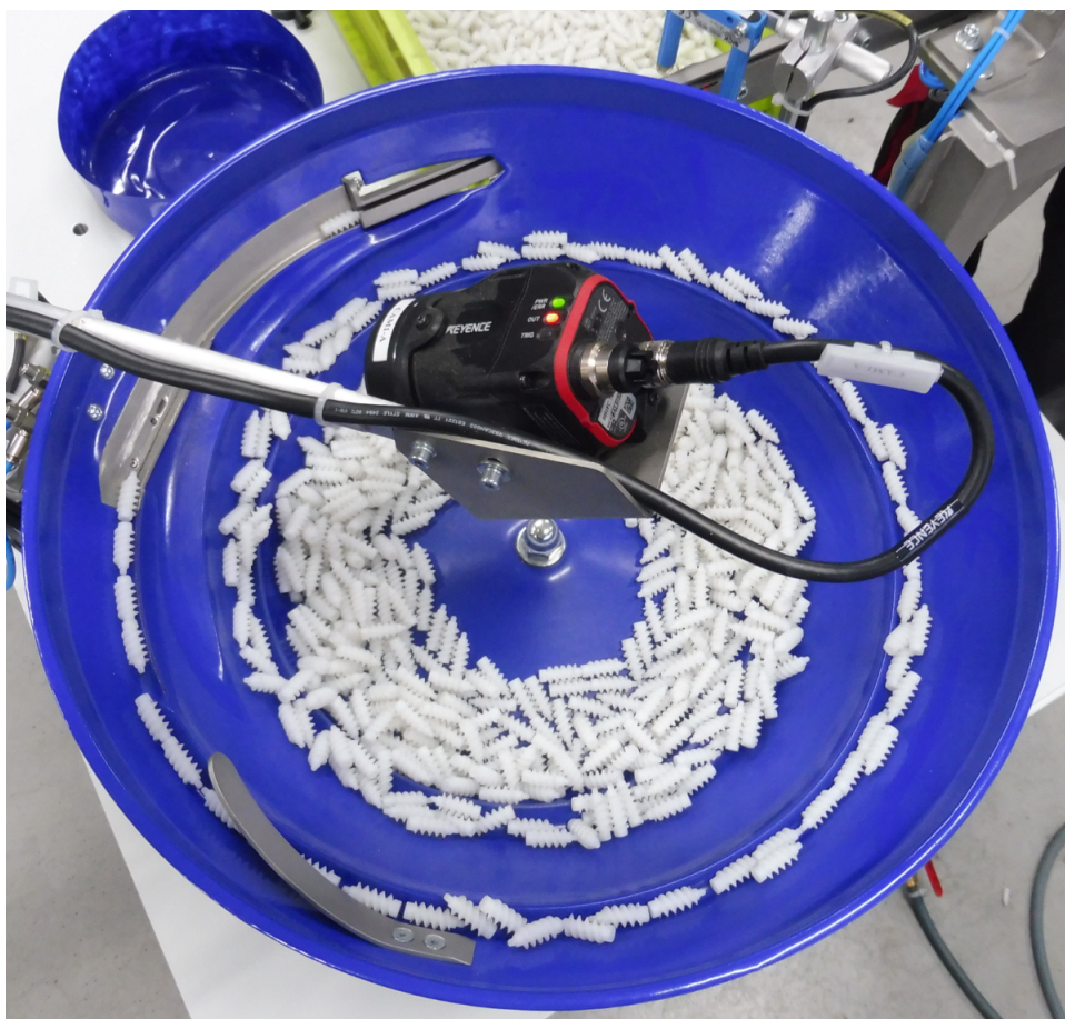
Obrázek 3.3: Kruhový zásobník podávající rotační díly pomocí optického snímání dílů.
