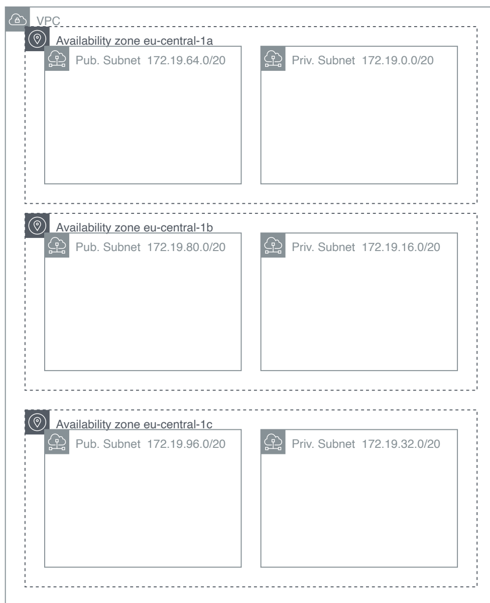
Obrázek 3.7: Rozvržení subnetů využitých pro aplikaci v jednom AWS regionu
