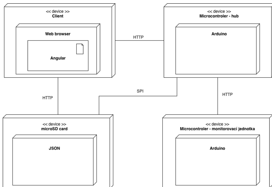
Obrázek 7.1. Diagram nasazení vlastního řešení.
