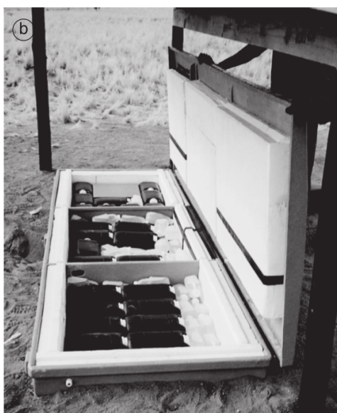
Obrázek 2.6: Foto pasivní stabilizace lahvemi s vodou
