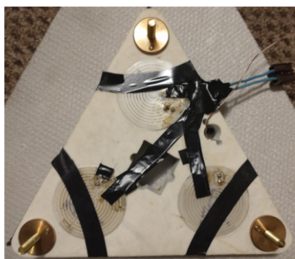
(a) : Umístění topných fólií a přívodů
