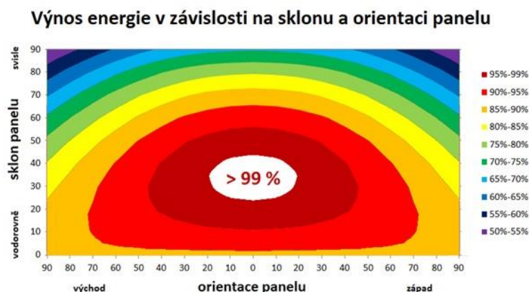
Obrázek 6: Výnos energie v závislosti na sklonu a orientaci panelu (42)
