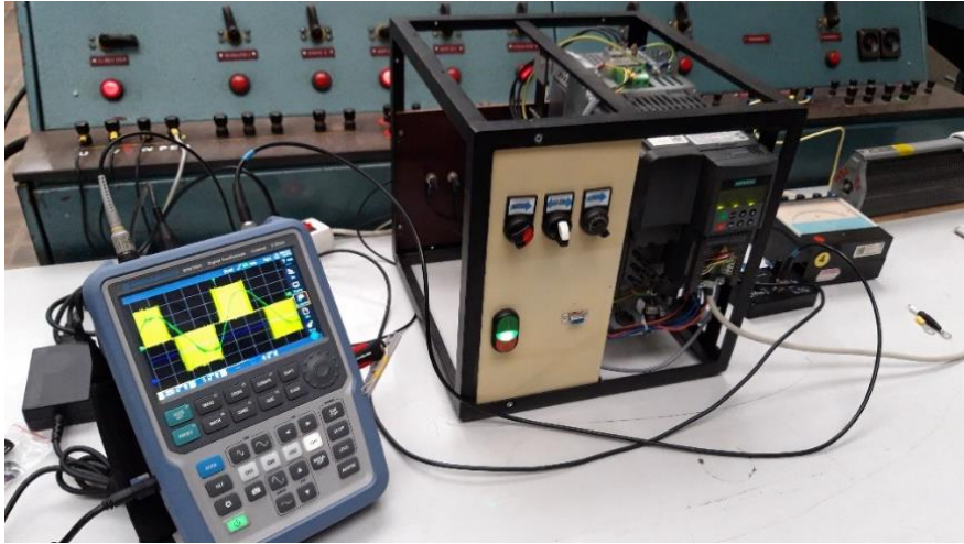
Obrázek 12.1.1.1 – fotografie pracoviště při měření napětí a proudu na výstupu měniče při motoru v chodu
