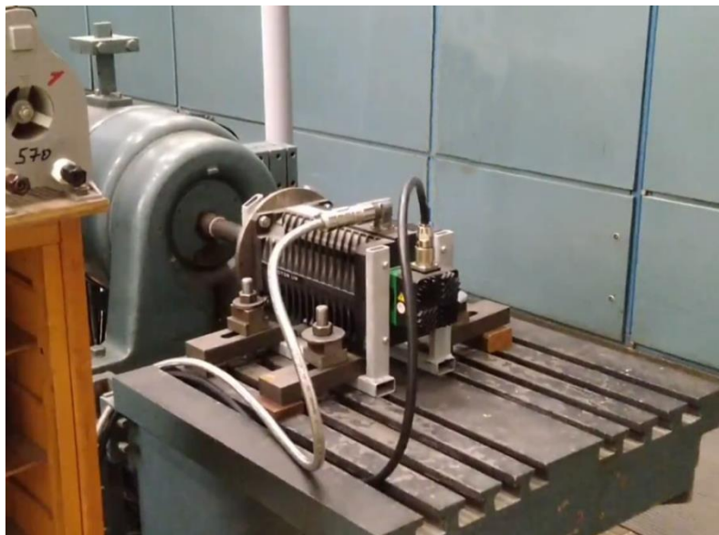
Obr. 4.14 - Dynamometr z opačné strany, na které je k němu přes spojku připojen PMSM s resolverem
