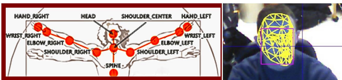
Obrázek 17: Kinect a jeho trasování kosterních kloubů a obličeje [86]
