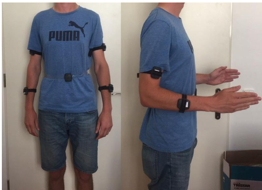
Obrázek 31: Umístění senzorů ProMove MINI na subjektu
