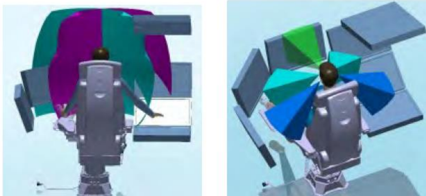
Obrázek 14: Modelová obálka dosažitelnosti prvků v kokpitu spolu s vizuálními možnostmi pilota [71]
