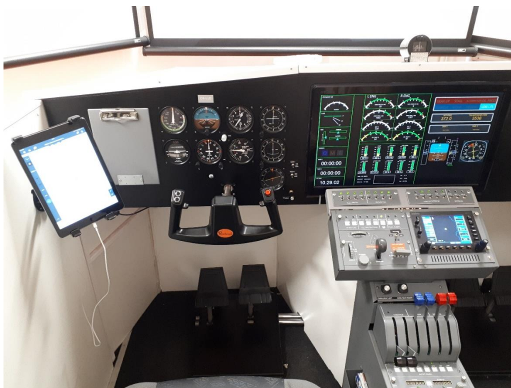
Obrázek 33: Kokpit letového simulátoru (na obrázku simulátor před zabudováním družicové navigace Garmin GTN750)
