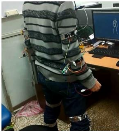
Obrázek 20: Příklad rozmístění akcelerometrických snímačů a jednoduchého modelu [58]
