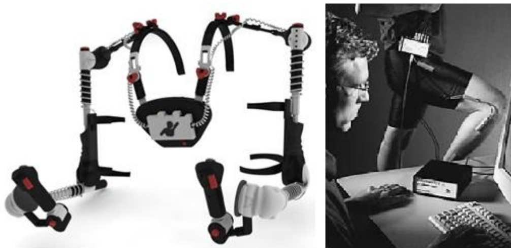
Obrázek 4: Mechanický snímací systém Gypsy™ MetaMotion (vlevo) spolu s elektrogoniometrem společnosti Biometrics Ltd (vpravo) [31, 35]
