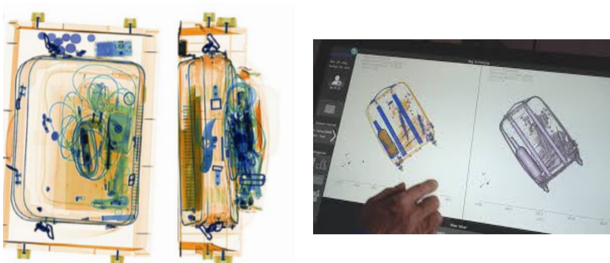
Obrázek 11: Snímek zavazadla ve dvou-pohledovém RTG vs obrázek ze 3D RTG zařízení. Zdroj: [20,21]
