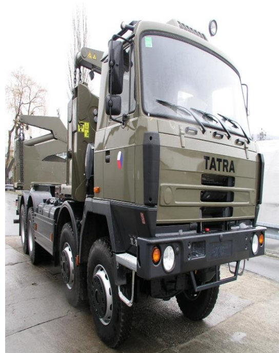
T 815 8x8 překladač kontejnerů STEELBRO [39]
