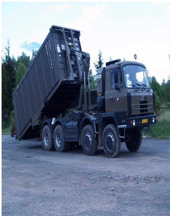
T 815 8x8 překladač kontejnerů MULTILIFT MK IV [39]
