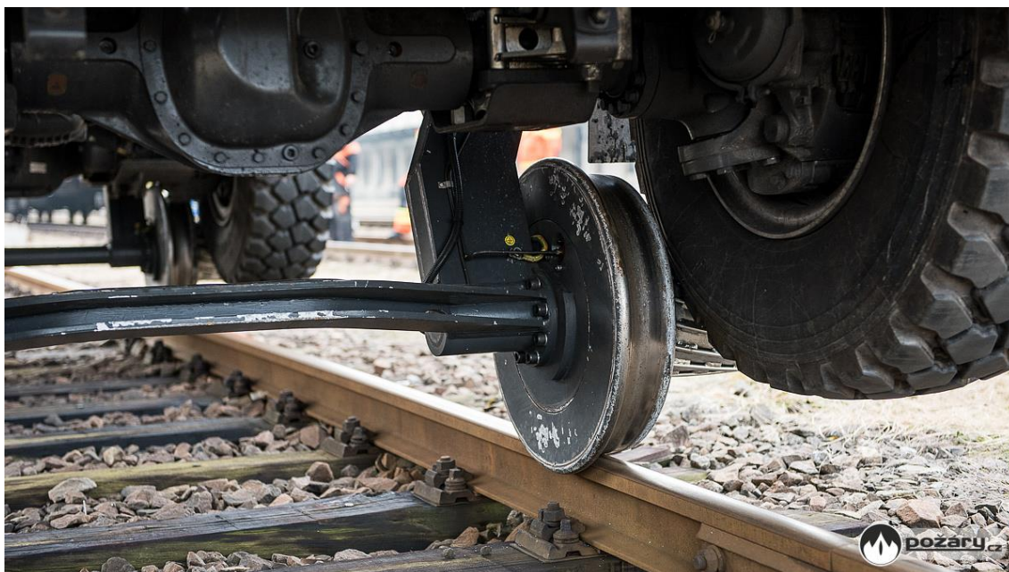
Obrázek 2 - Kolejové adaptéry vozidla Renault D14 UniRoller-V (zdroj: Požáry.cz)
