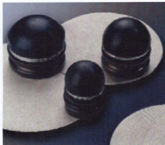
Obrázek 4.4 – Gumový nástroj pro broušení u free-form technologie [24]
