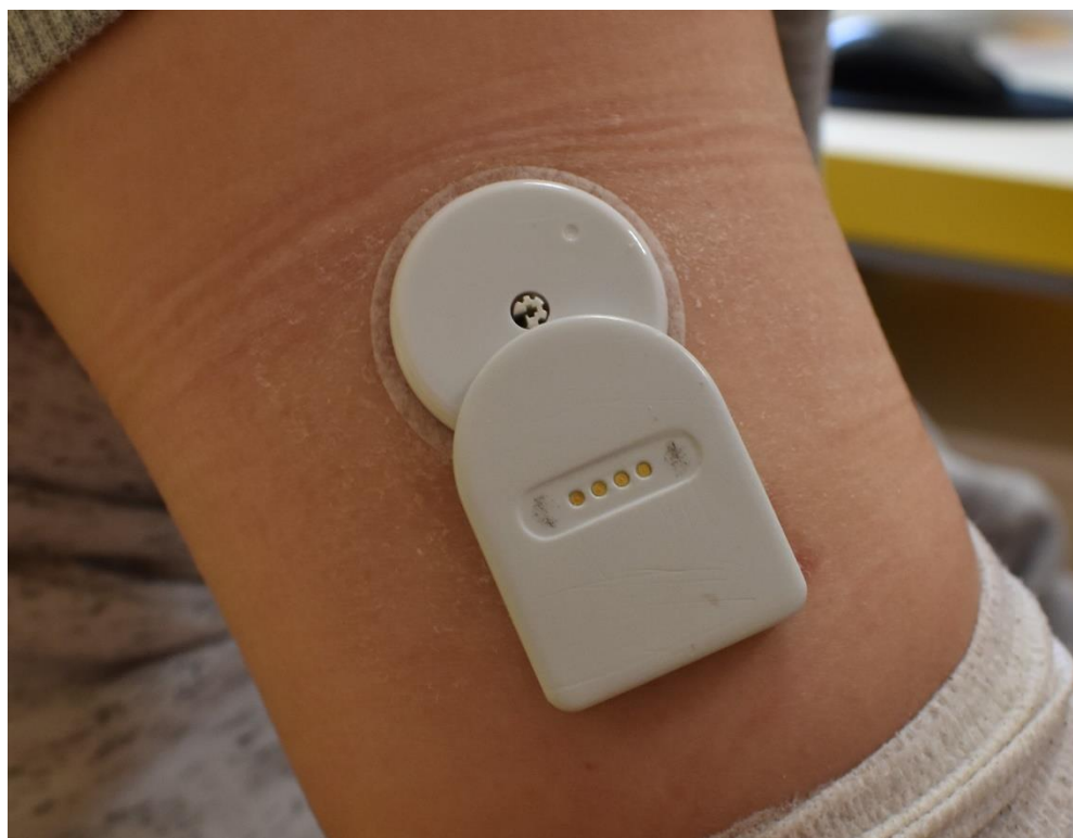
Obrázek 10 - MiaoMiao připevněné k senzoru FreeStyle Libre [vlastní zdroj]
