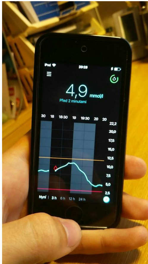
Obrázek 4 - mobilní telefon jako přijímač [vlastní zdroj]
