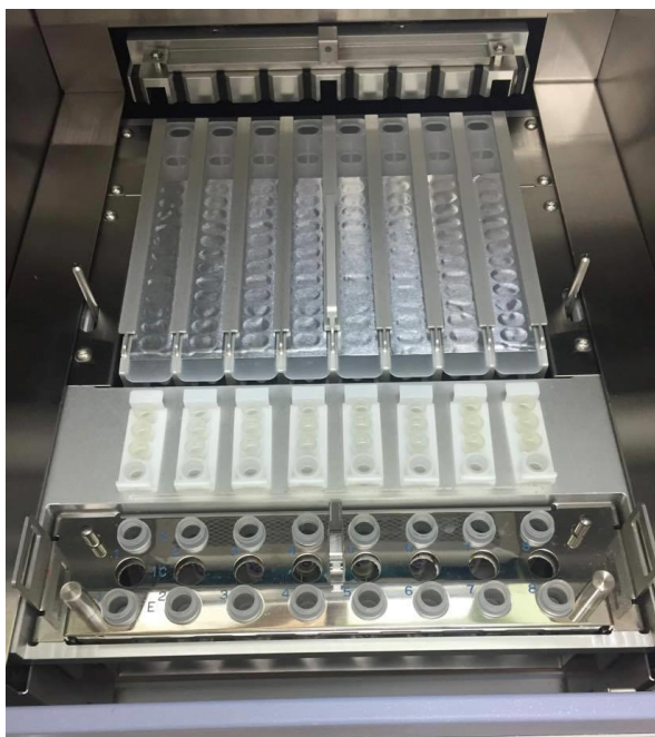
Obrázek 8 Pracovní prostor izolátoru připravený před zahájením izolace (vlastní zdroj)
