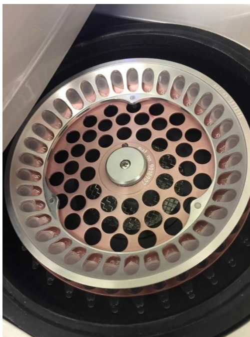
Obrázek 11 Rotor umístěný v analyzátoru před spuštěním vlastní analýzy (vlastní zdroj)
