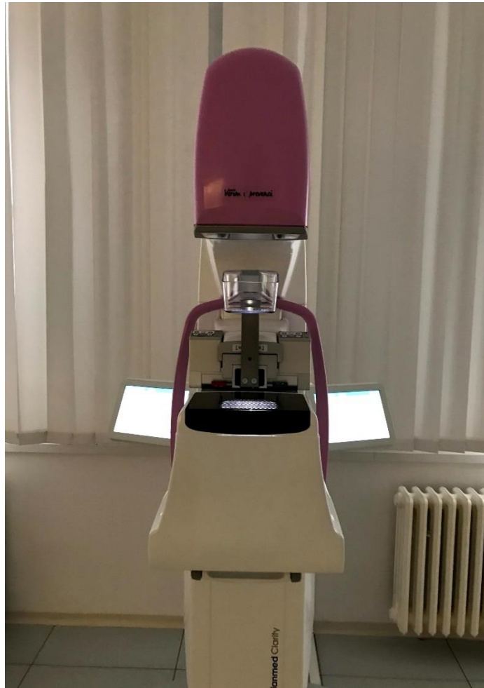
Obrázek 18: Nástavec pro zvětšení a malá kompresní deska (Foto autor)
