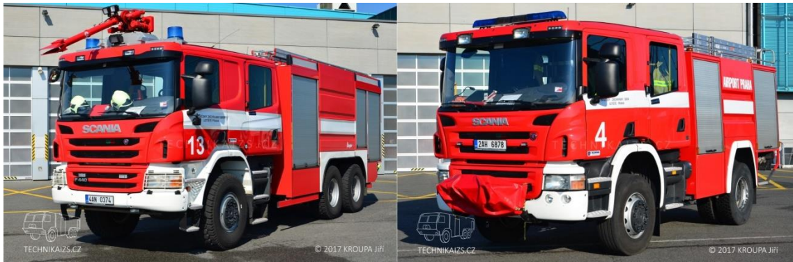
Obrázek 7 – Rozdíl dvou hlavních zásahových automobilů Scania (vlevo Scania K30 6x4 P440 CB HHZ Ziegler, vpravo Scania K30 4x4 P400 CB) [36]
