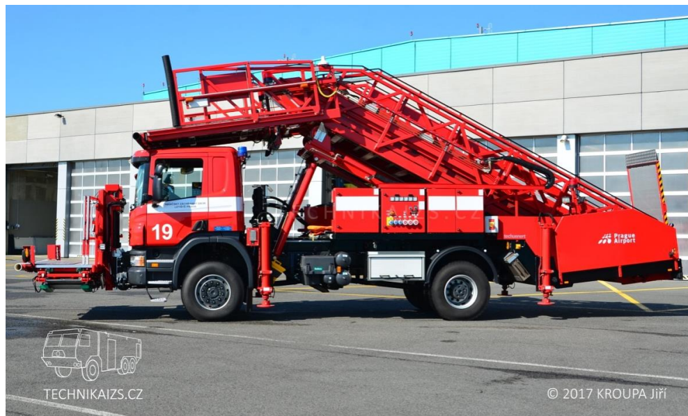
Obrázek 12 – Požární záchranné schody [36]
