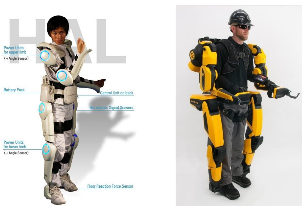
Obr. 2.6: Příklad elektrického exoskeletu (převzato z [36] [37] )
