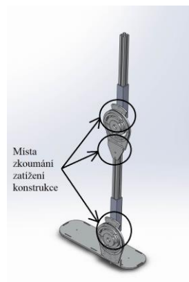
Obr. 4.15: Segmenty zkoumání zatížení konstrukce.
