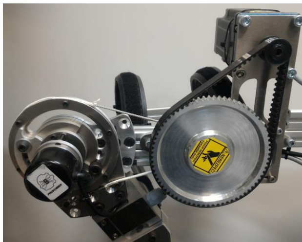
Obr. 5.6: Realizovaný systém přenosu momentových účinků na exoskeletu
