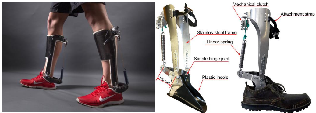
Obr. 2.4: Příklad čistě mechanického exoskeletu (převzato z [30][31])
