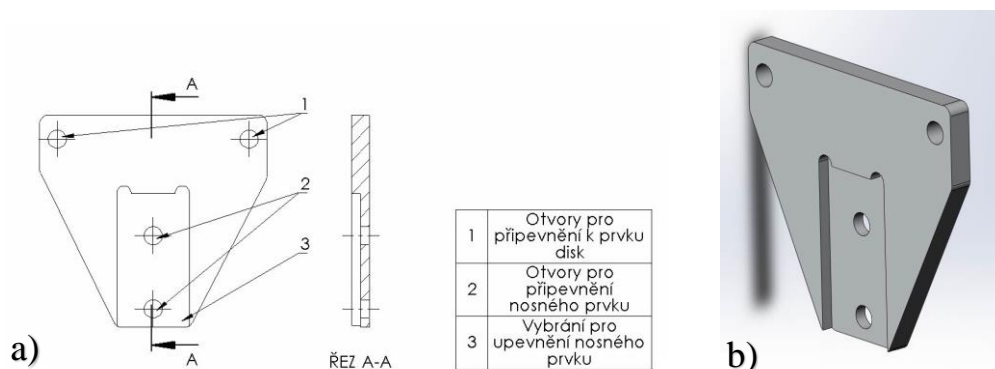
Obr. 4.4: a) Popis konstrukce držáku disku b) axonometrická projekce
