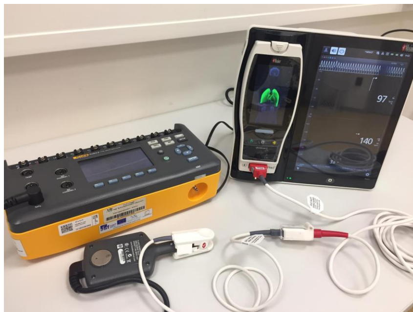
Obr.5.3: Simulátor SpO 2 napojený na pulzný oxymeter Masimo ROOT
